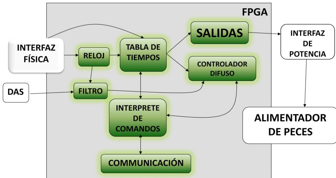
Figura 3.19. Diagrama general del diseño de más alto nivel.
