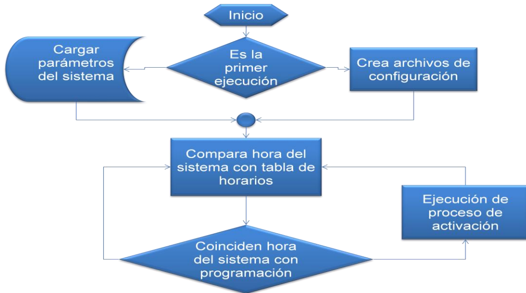
Figura 1.1. Proceso principal, diagrama de solución implementada en PC.
