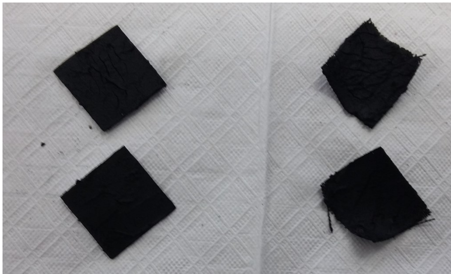
Figura 4.6 Electrodo de trabajo con fotocatalizador dispersado sobre la superficie.
