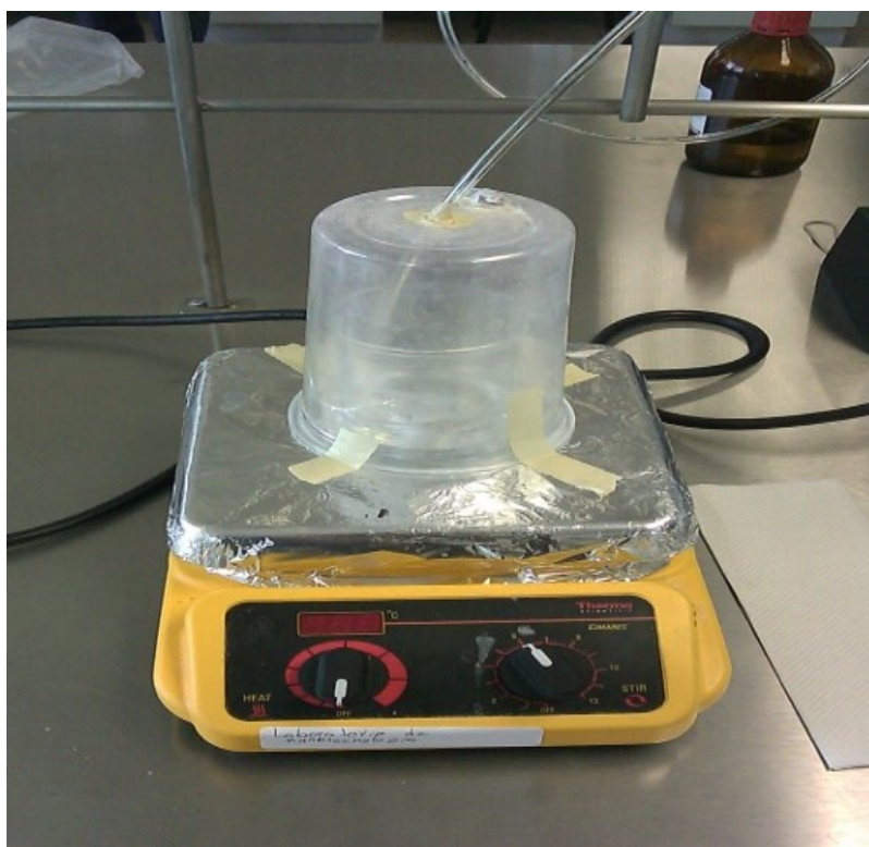
Figura 4.2 Sistema de reacción controlando una atmósfera inerte al emplear un flujo constante de hidrogeno
