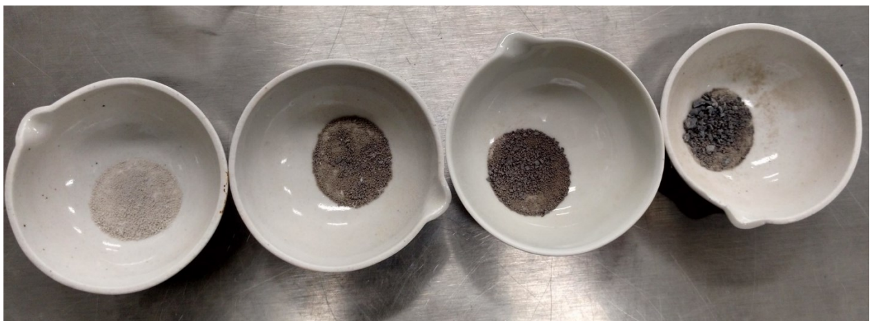
Figura 4.4 Muestras de Pt-TiO 2 a diferentes concentraciones de platino después de la calcinación a 550°C.
