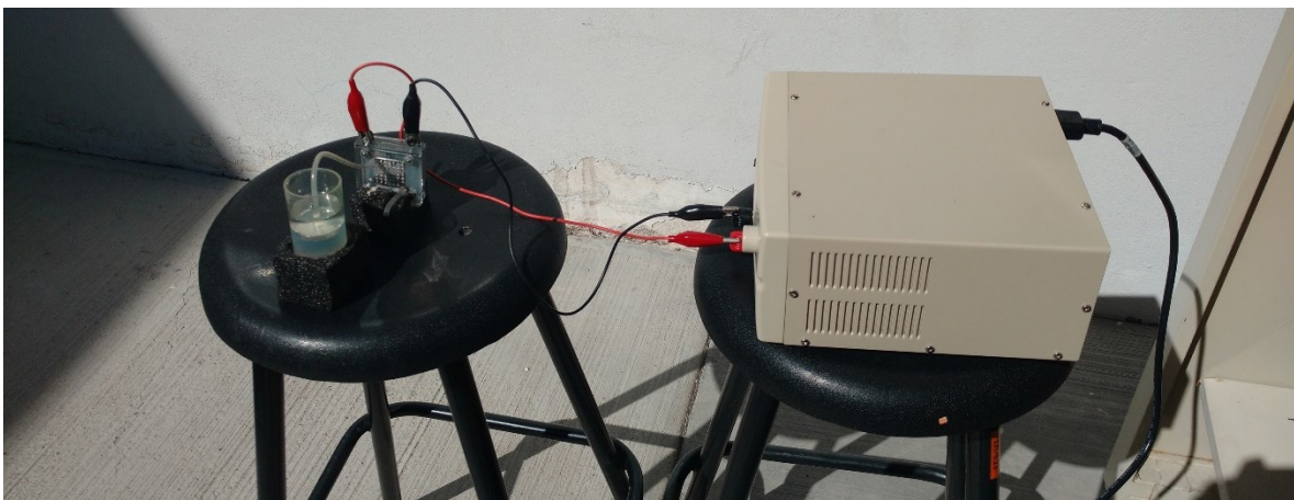
Figura 4.10 Electrolizador fotocatalítico tipo PEM.
