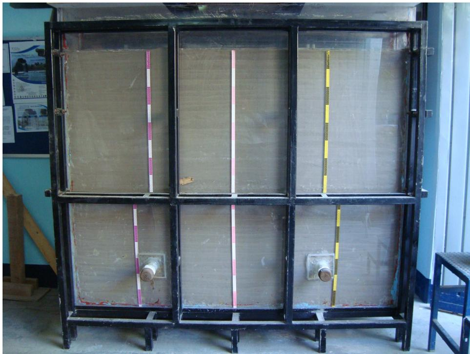
**Figura 4.9. Colocación del suelo en el módulo de drenaje**
