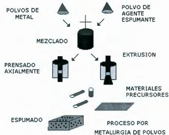
Figura 18. Método de descomposición de agente espumante en metal sólido (IFAM).
