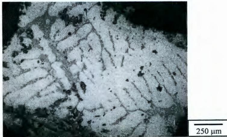
Figura 37. Micrografía de la espuma A con ataque químico.
