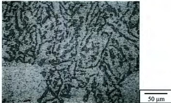
Figura 35. Eutético Al-Si de la espuma A.
