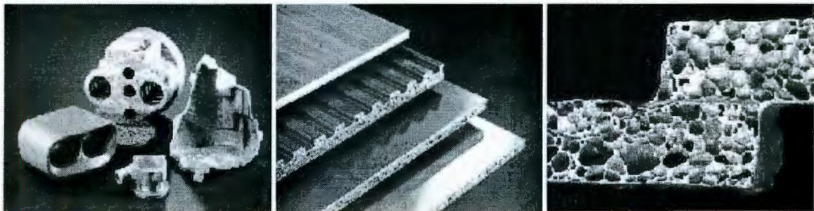
Figura 5. Diversas aplicaciones de las espumas de aluminio
