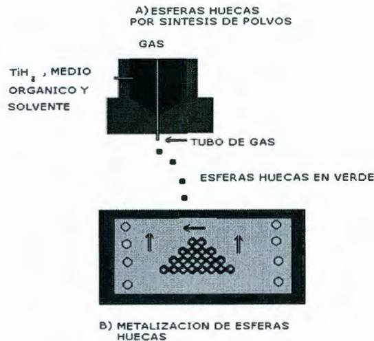
Figura 16. Esquema de producción por esferas huecas.
