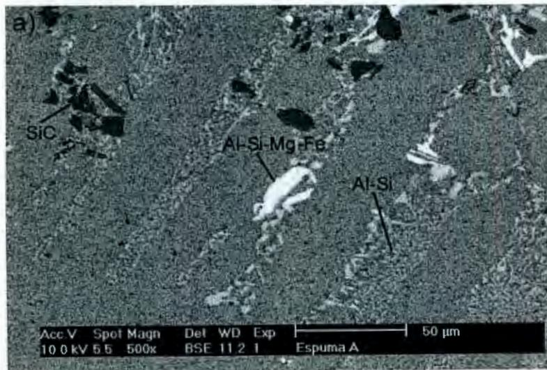
Figura 41. Microestructura típica de la espuma A.
