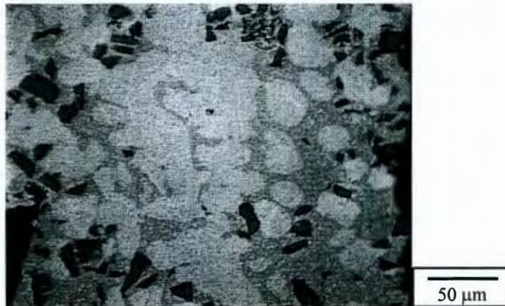
Figura 34. Crecimiento dendrítico de la espuma C.
