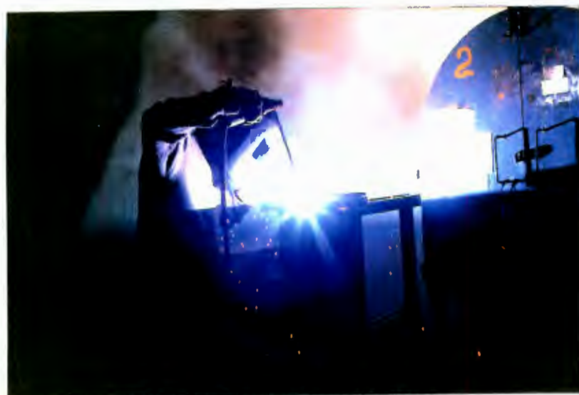
DURANTE LA SOLDADURA DE LA PROBETA DE FRACTURA EN 'Y'.
