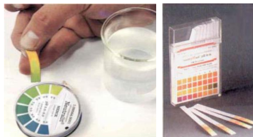
Figura 46. Uso de cintas de papel para la medición de pH.
