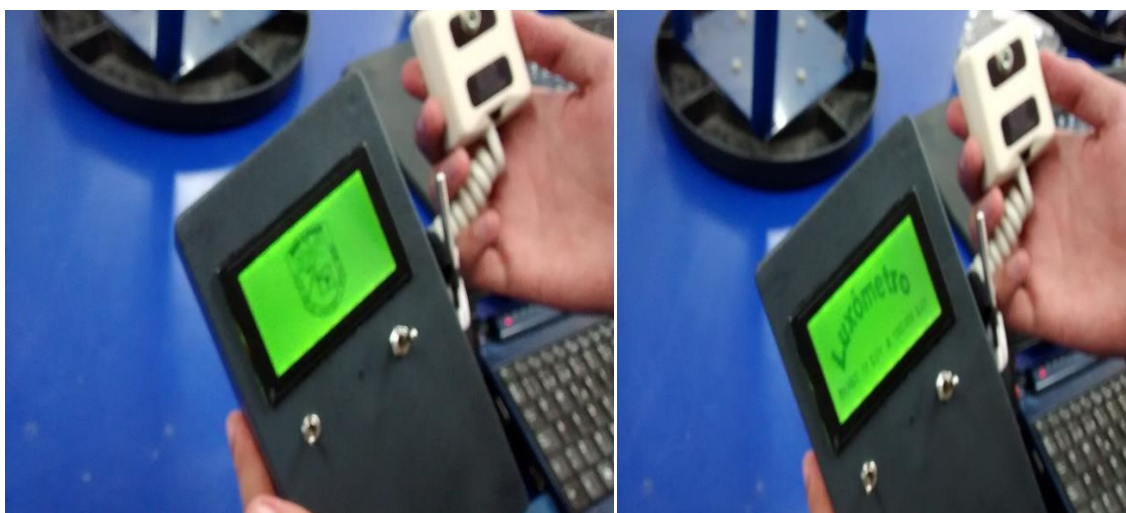
Figura 60. Segundo diseño del luxómetro.
