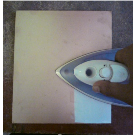
Figura 111. Aplica calor por 5 minutos a la capacidad media de la plancha.
