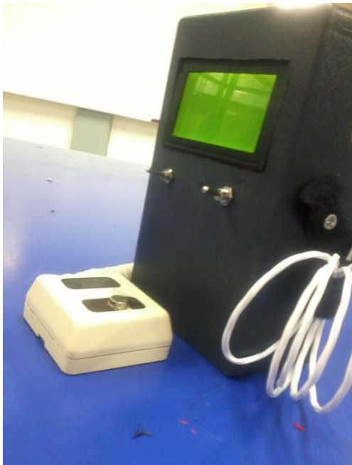
Figura 62. Parte trasera y parte delantera del luxómetro.
