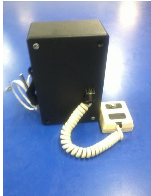
Figura 62. Parte trasera y parte delantera del luxómetro.
