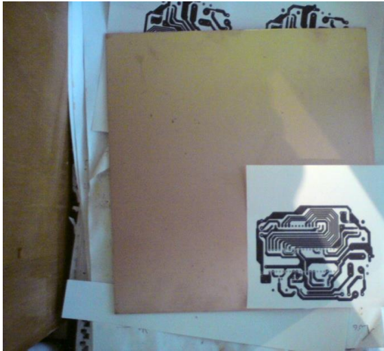
Figura 110. Pega la impresión con cinta adhesiva asegura que no se mueva.
