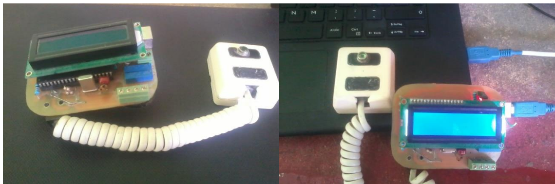
Figura 58. Conexión del luxómetro a la computadora.
