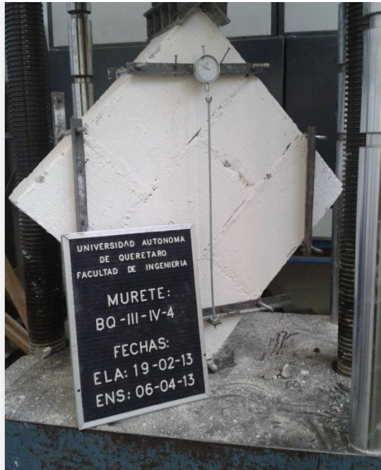
Figura 22: Murete preparado para prueba de compresión diagonal.
