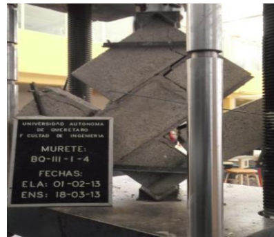
Figura 31.- M BQ II-1-4 Después de la prueba a compresión diagonal.
