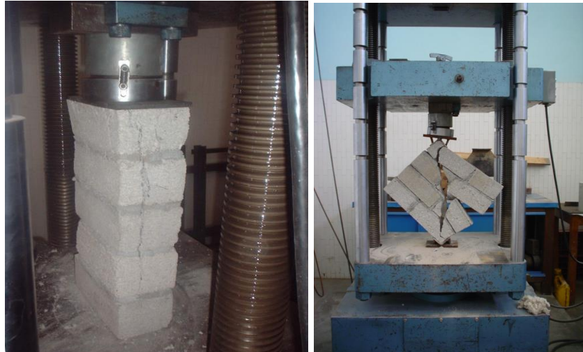
Figura 18.- Ensaye de pila y murete de tabicón de concreto.
