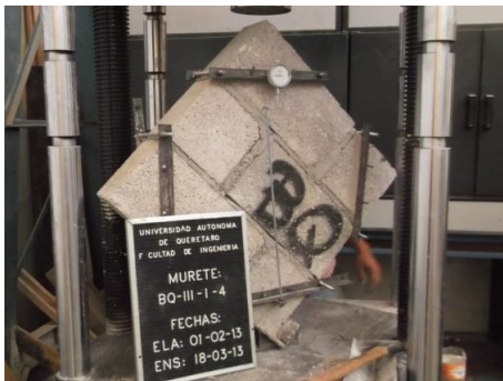
Figura 30.- M BQ II-1-4 Antes de la prueba a compresión diagonal.
