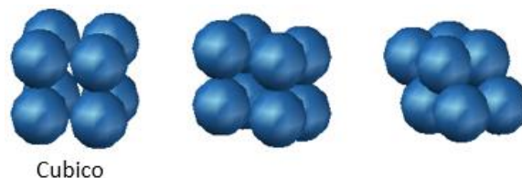
Fig. 3.6 Esquema del reacomodo de partículas esféricas uniformes, reduciendo la porosidad. Modificado de: (Boggs Jr., 2006).
