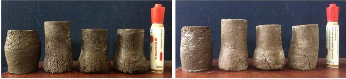
Fig. 6.9 Fotografías de las probetas deformadas y agrietadas después del ensaye triaxial.
