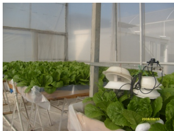
Figura 3.2. Sensores de CO 2 , Temperatura, Humedad relativa y radiación.
