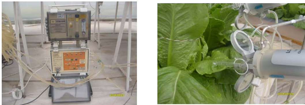
Figura 3.3 a) Medidor de fotosíntesis utilizado en los cultivos de lechuga y pepino b) Cámaras del medidor de fotosíntesis.
