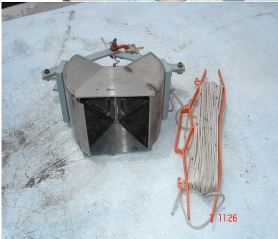
Figura 3.2 Muestreadores tipo botella Van Dorn y draga Petersen utilizados para agua y sedimento, respectivamente.
