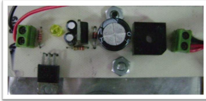
Figura 3.20. Tarjeta de alimentación para el KIT de desarrollo ALTERA.
