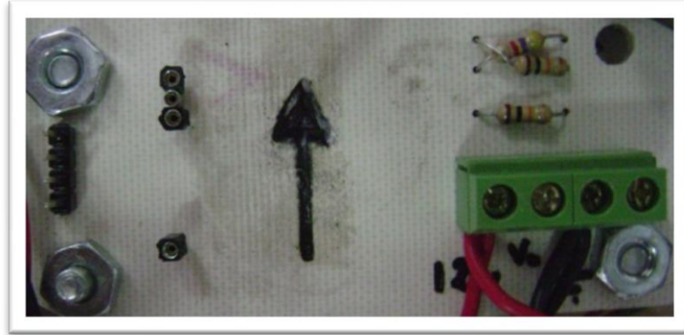
Figura 3.18. Tarjeta de conexión de la antena XBEE y monitoreo del voltaje de la batería.
