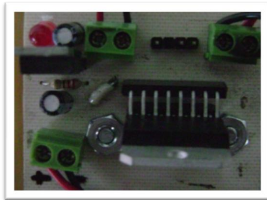
Figura 3.19. Puente H, Tarjeta utilizada para la conexión de los motores.
