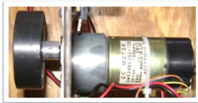
Figura 3.36. Motor y rueda fijas al módulo de monitoreo espacial.
