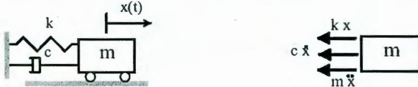
Fig. 2.2 Sistema de un grado de libertad con amortiguamiento y su diagrama de cuerpo libre.
