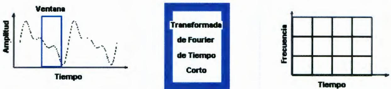
Figura 1.6: Algoritmo de Transformada de Fourier de Tiempo Corto.
