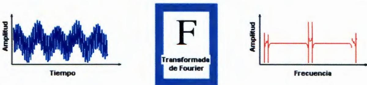
Figura 1.1: Mediante la transformada de Fourier de una señal en el dominio del tiempo se obtiene su análisis espectral.
