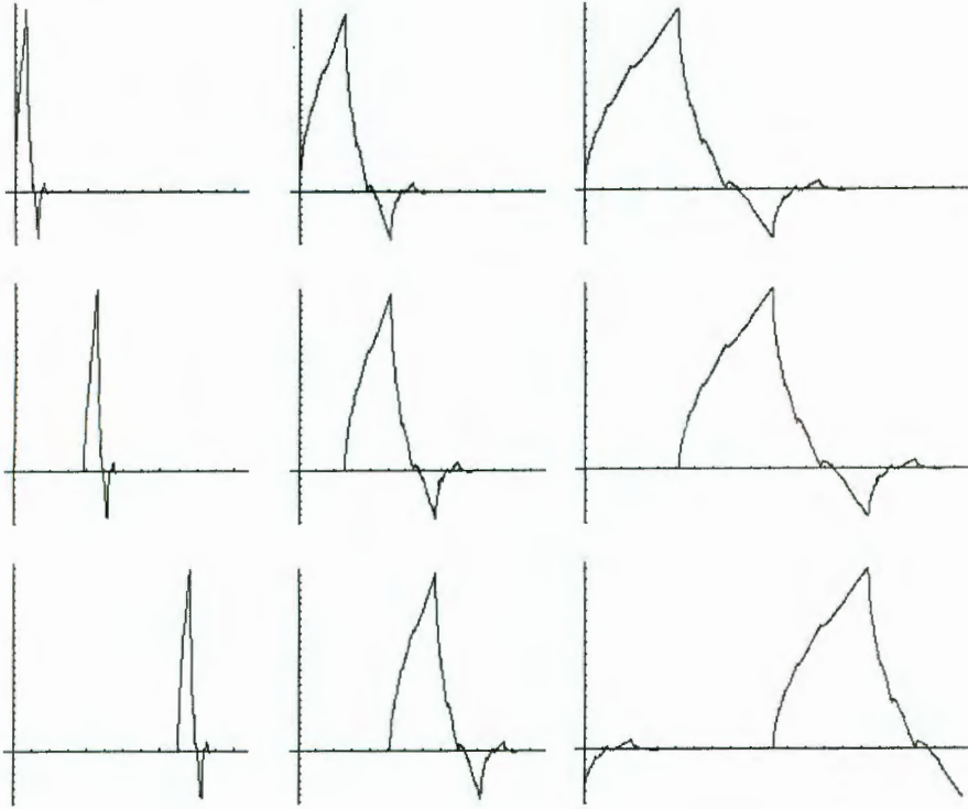
Figura 4.3: Señales o funciones de Escalamiento para el wavelet Daubechie – Desplazamiento y dilatación.
