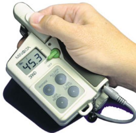
**Figura 3.10.** Medidor de clorofila SPAD-502
