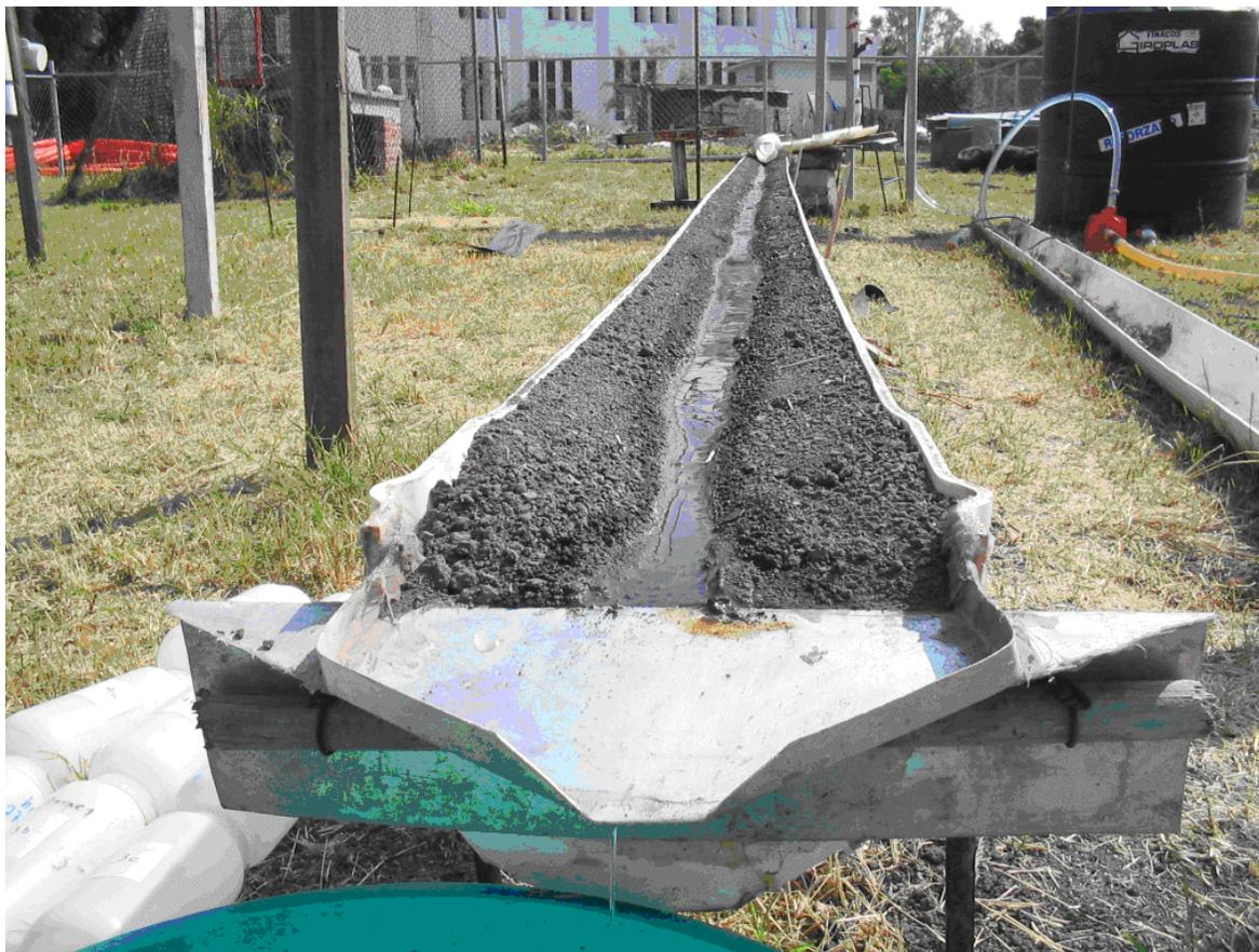
**Figura 3.1.** Canal para medir erosión
