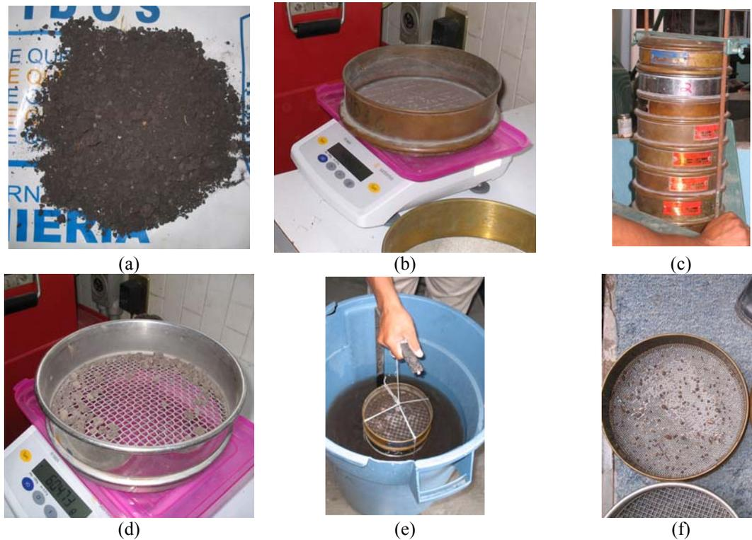
Figura 4.3. Proceso de obtención de la curva de distribución de agregados.
