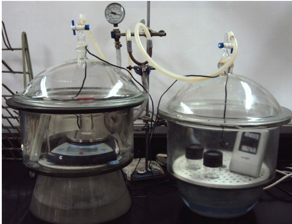
Figura 6. Sistema de medición de permeabilidad al vapor de agua.
