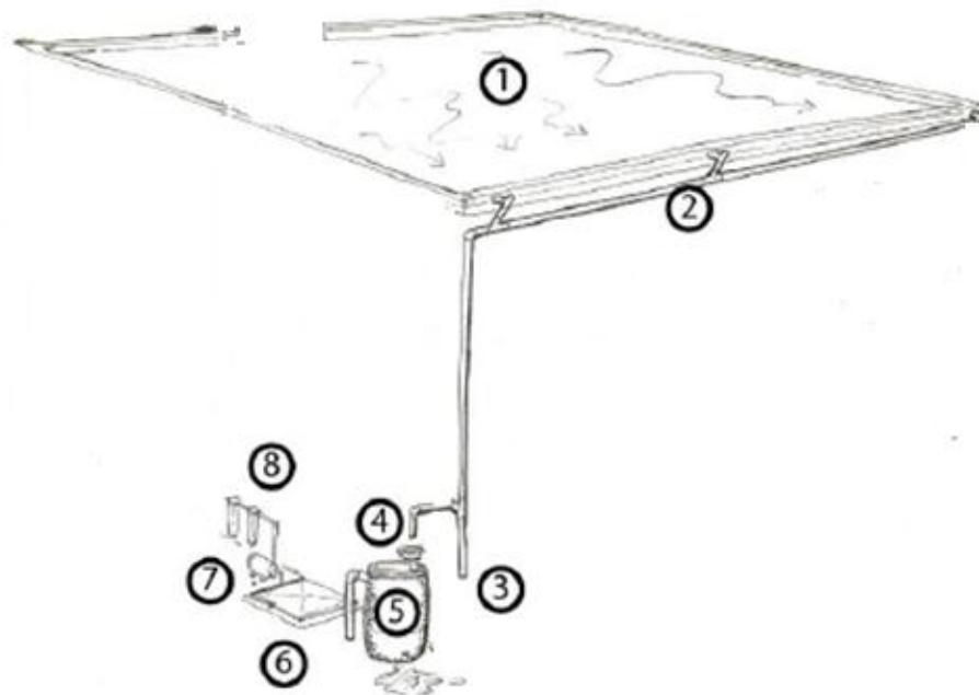
Figura 3.4 esquema de un sistema de captación. (CONAFOR)
