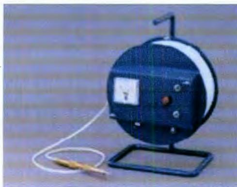
**FIGURA 4.13.- CARRETE DE SONDA ELÉCTRICA**
