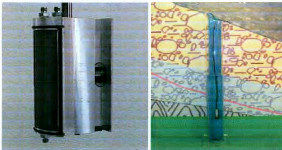
**FIGURA 4.8.- MEDIDOR DE PRESIÓN PIEZÓMETRO.**
