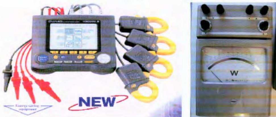
**FIGURA 4.18.- WATTMETRO DIGITAL Y ELECTRODINÁMICO.**
