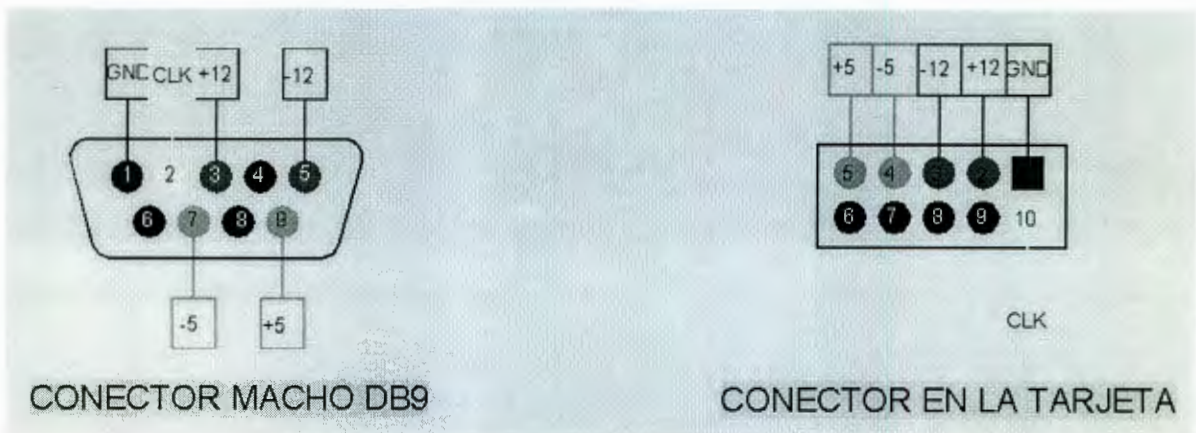
Figura 6.6 Configuración del conector DB9 y conector en la tarjeta de expansión
