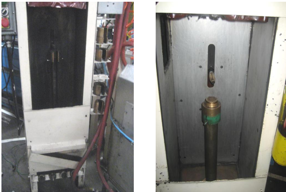
Fig. 12. Máquina Reforzadora de Amortiguador. Limpieza interna.
