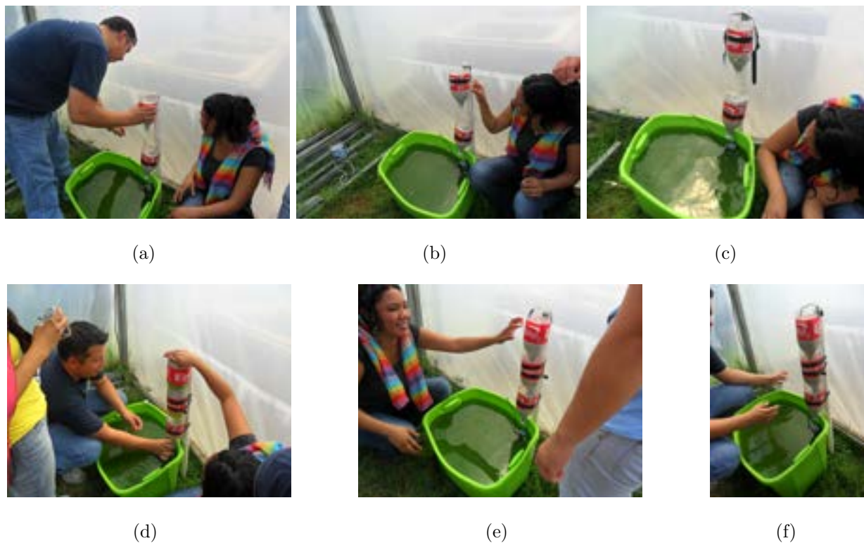
Figura 23: Pruebas Preliminares: Configuración del biofiltro up-down
