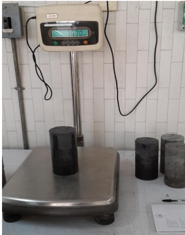
Fig. 37 Determinación del peso de los cilindros de concreto después de ser extraídos del proceso de curado.
