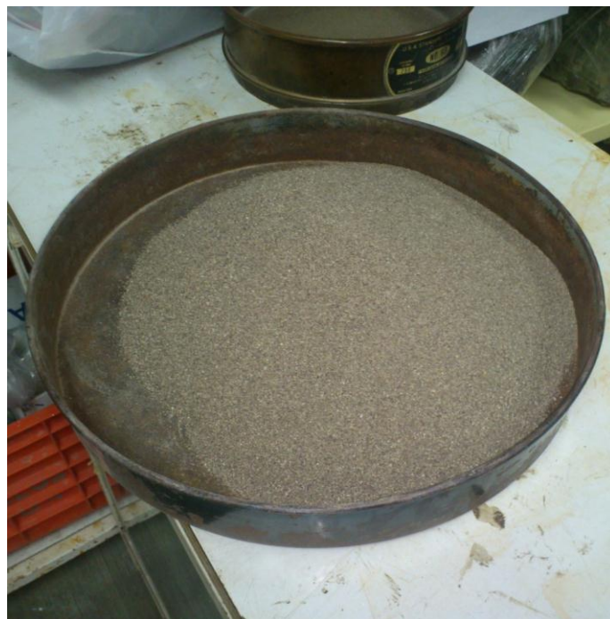
Fig. 19 Arena que pasa por la malla no. 30 y se retiene en la malla no. 60.
