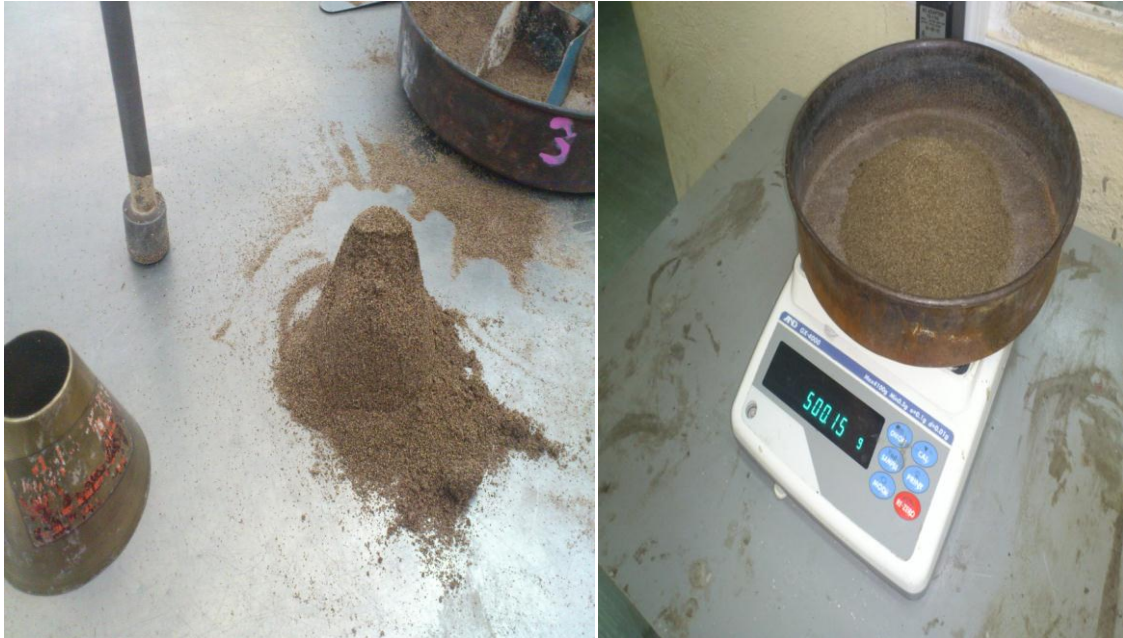
Fig. 21 Prueba del cono de arena, del lado izquierdo material en condición saturado y superficialmente seco. Del lado derecho 500 gr de material en dicha condición para ser introducido al horno durante 24 h.
