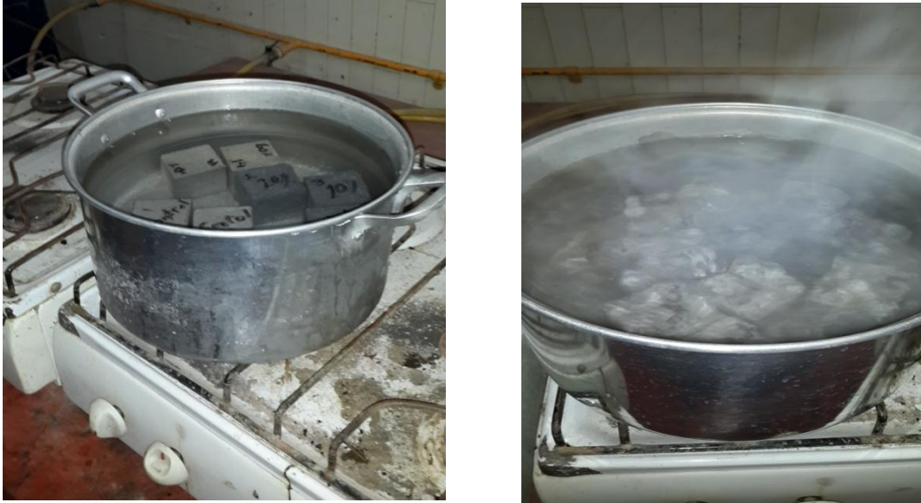
Fig. 44 Del lado izquierdo se muestran los cubos recién colocados al fuego, del lado derecho se muestran los cubos en ebullición para obtener el valor C de la norma ASTM C 642-06.
