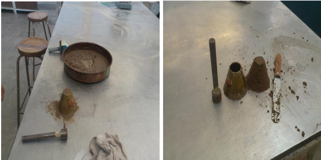
Fig. 20 Prueba del cono de arena, material saturado siendo secado parcialmente.
