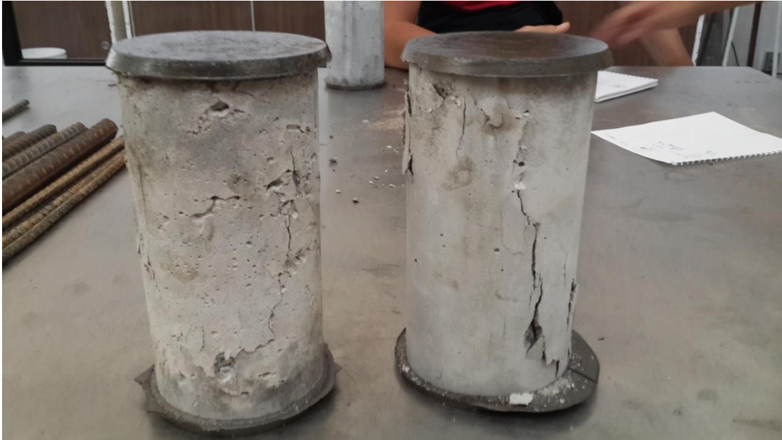
Fig. 40 Fallas ocurridas en los cilindros de control.
