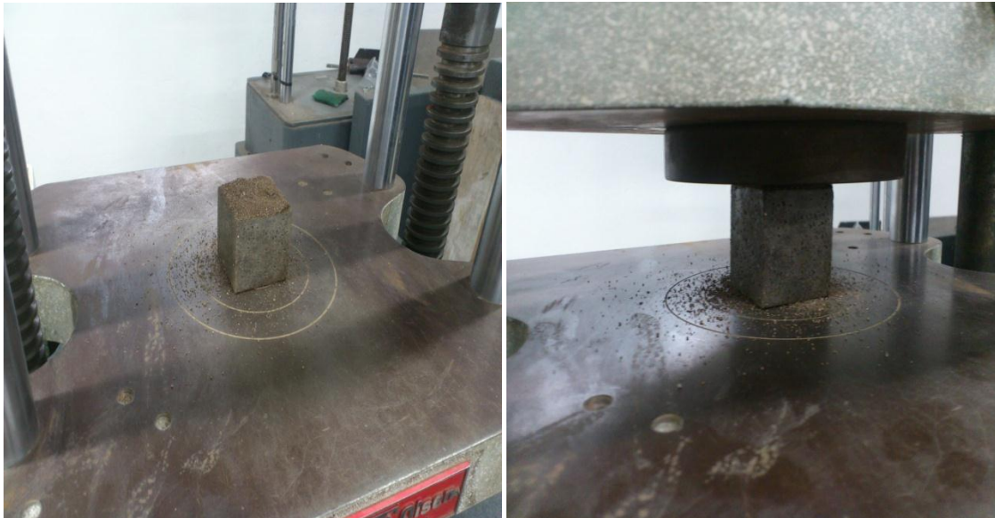
Fig. 35 Cubos de mortero colocados en maquina universal para prueba de compresión.
