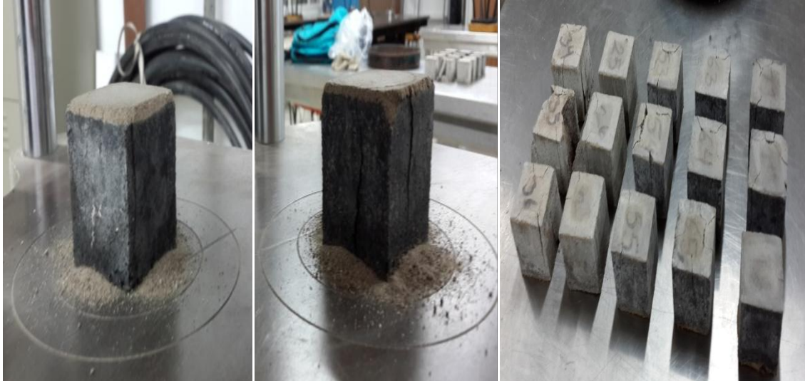
Fig. 36 Diferentes tipos de fallas presentes en los morteros.
