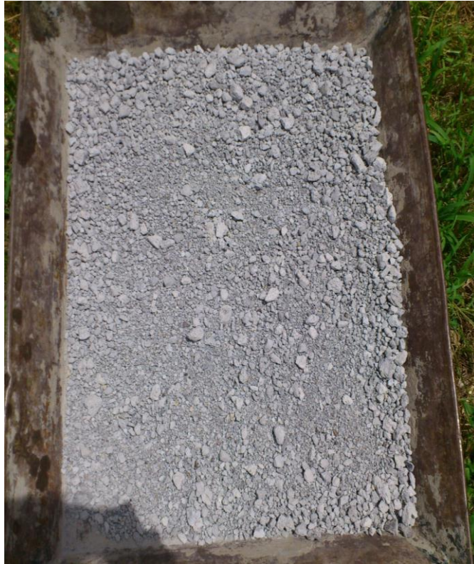
Fig. 8 Piedra pómez colocada en charola con humedad natural para posteriormente introducirla al horno de secado.
