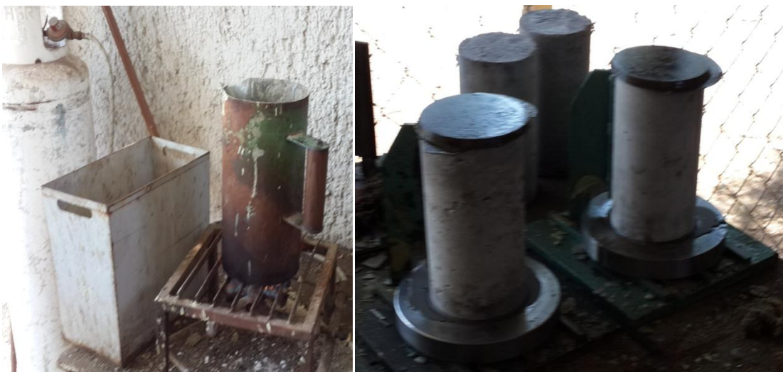
Fig. 38 A la izquierda preparación de azufre, a la derecha cilindros parcialmente cabeceados.
