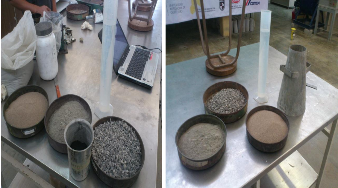
Fig. 30 Agregados para realizar mezcla de concreto y molde para verificar revenimiento.
