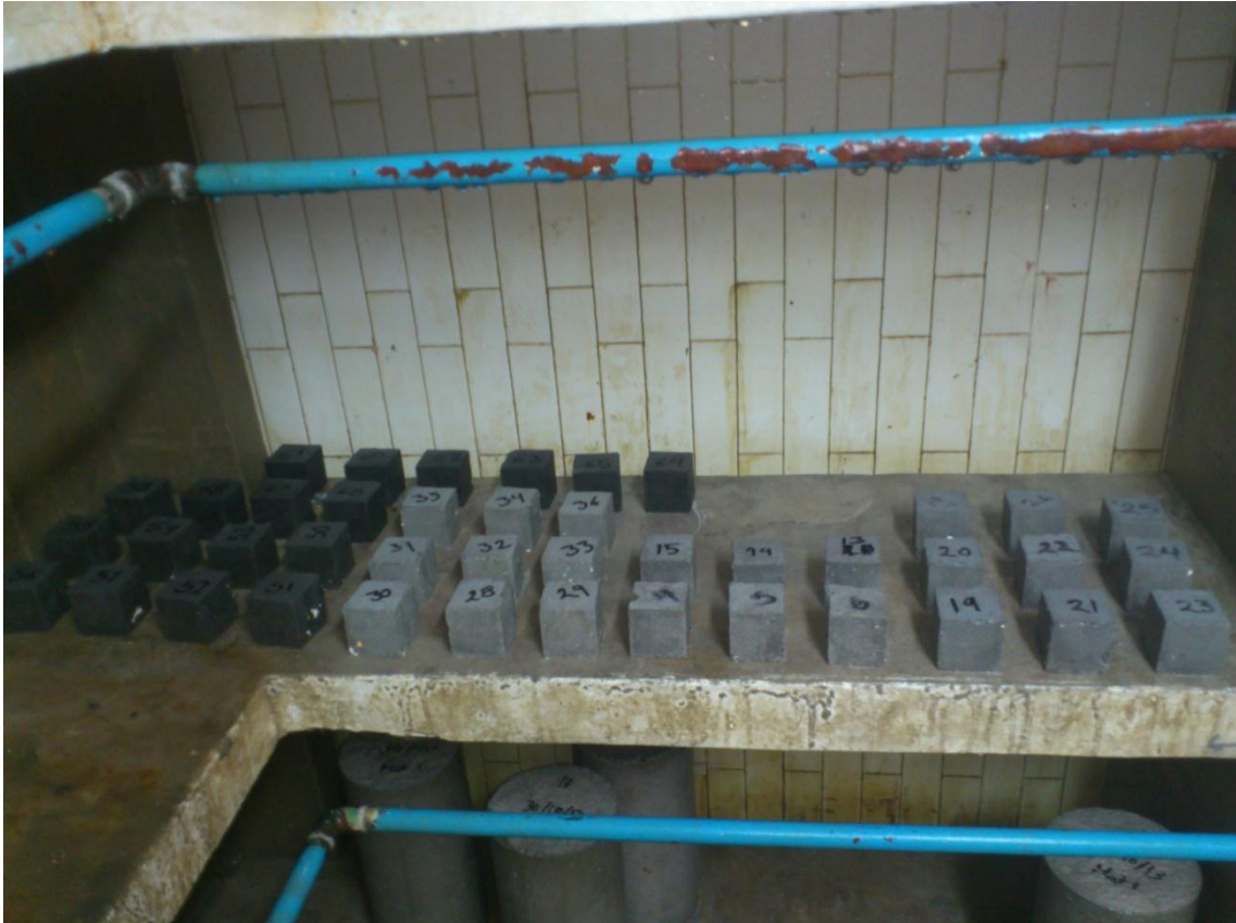
Fig. 29 En la parte izquierda cubos con sustitución de CCA, en el centro cubos de control (sin sustitución) y en la parte derecha cubos con sustitución de CBC.
