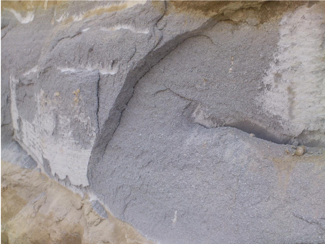
Fig. 7 Estrato de aproximadamente 1.5m a 2m compuesto de piedra pómez donde se recolecto el material.
