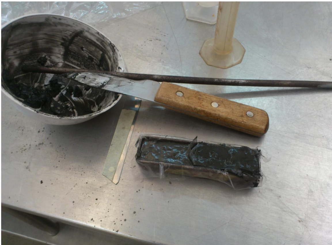
Fig. 51 Pasta de cemento con sustitución de CCA colocada en molde para contracción
