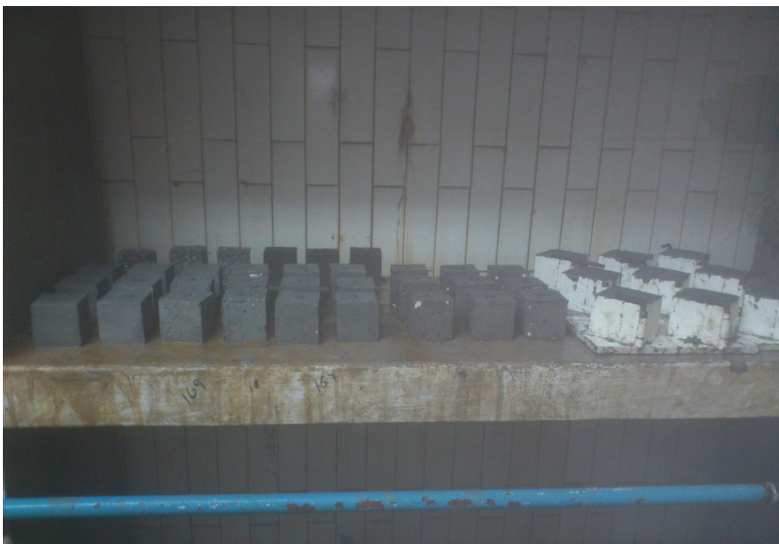
Fig. 28 Cubos de mortero y moldes con mezcla en la cámara de curado.
