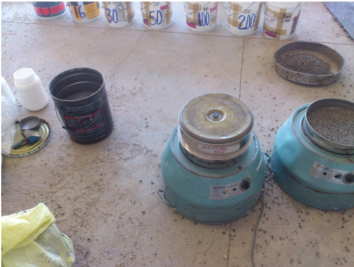
Fig. 25 Criba de los materiales por medio de tamizador de control.
