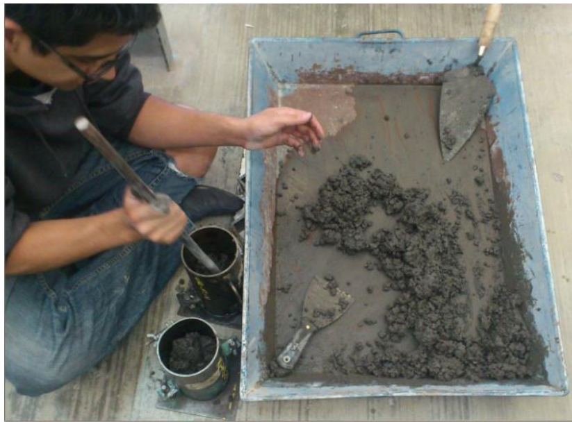
Fig. 32 Moldeado de cilindros de concreto.
