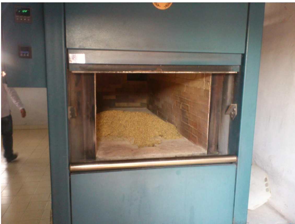
Fig. 14 Horno crematorio utilizado para incinerar la cascara de arroz ubicado en la ciudad de San Miguel de Allende, Guanajuato.
