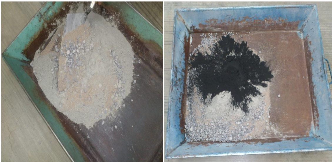
Fig. 31 Del lado izquierdo materiales para mezcla de concreto sin sustitución, del lado derecho mezcla de concreto con 20% de sustitución de CCA.
