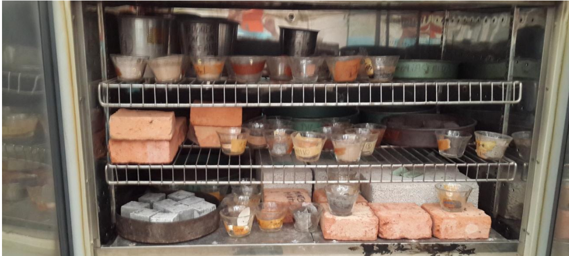
Fig. 43 Cubos de concreto ingresando al horno para periodo de secado.
