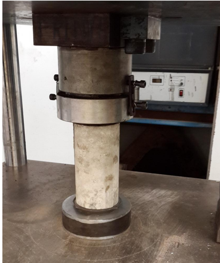
Fig. 39 Cilindro colocado en la maquina universal en espera de aplicación de carga.
