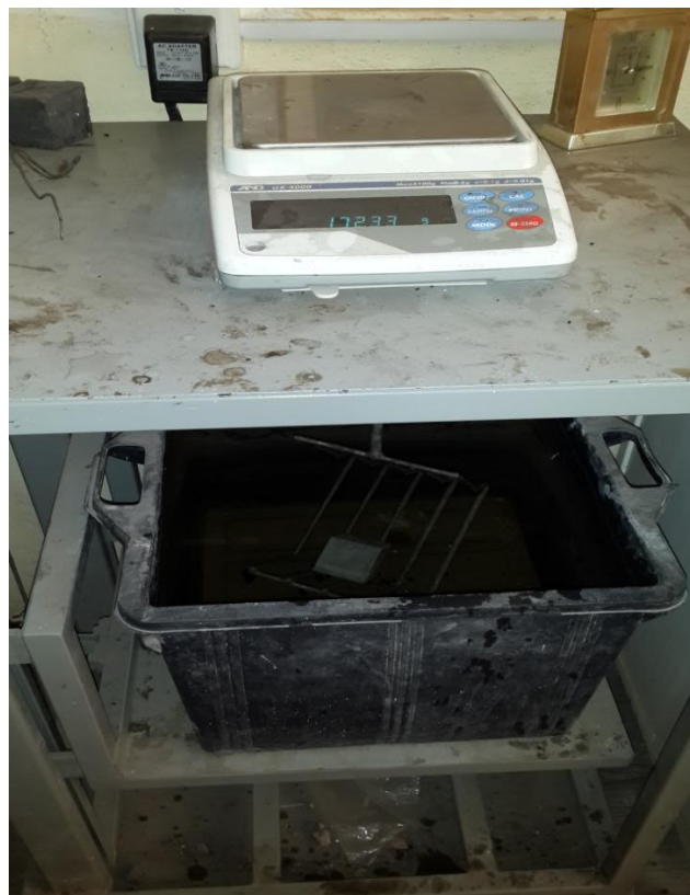
Fig. 45 Determinación del peso sumergido de los cubos de concreto.
