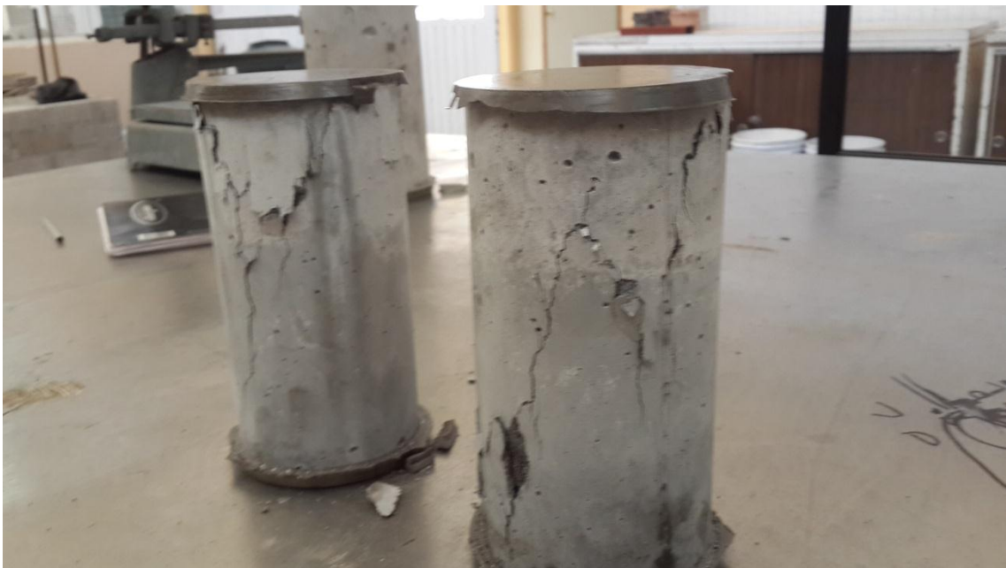
Fig. 41 Fallas ocurridas en los cilindros con 20% de sustitución de CCA.
