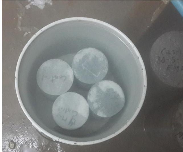
Fig. 33 Cilindros de concreto inmersos en agua.
