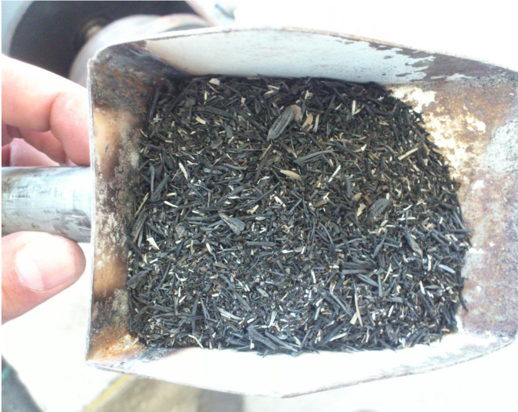
Fig. 16 Muestra del tipo de ceniza de cascara de arroz obtenida después del proceso de quema.
