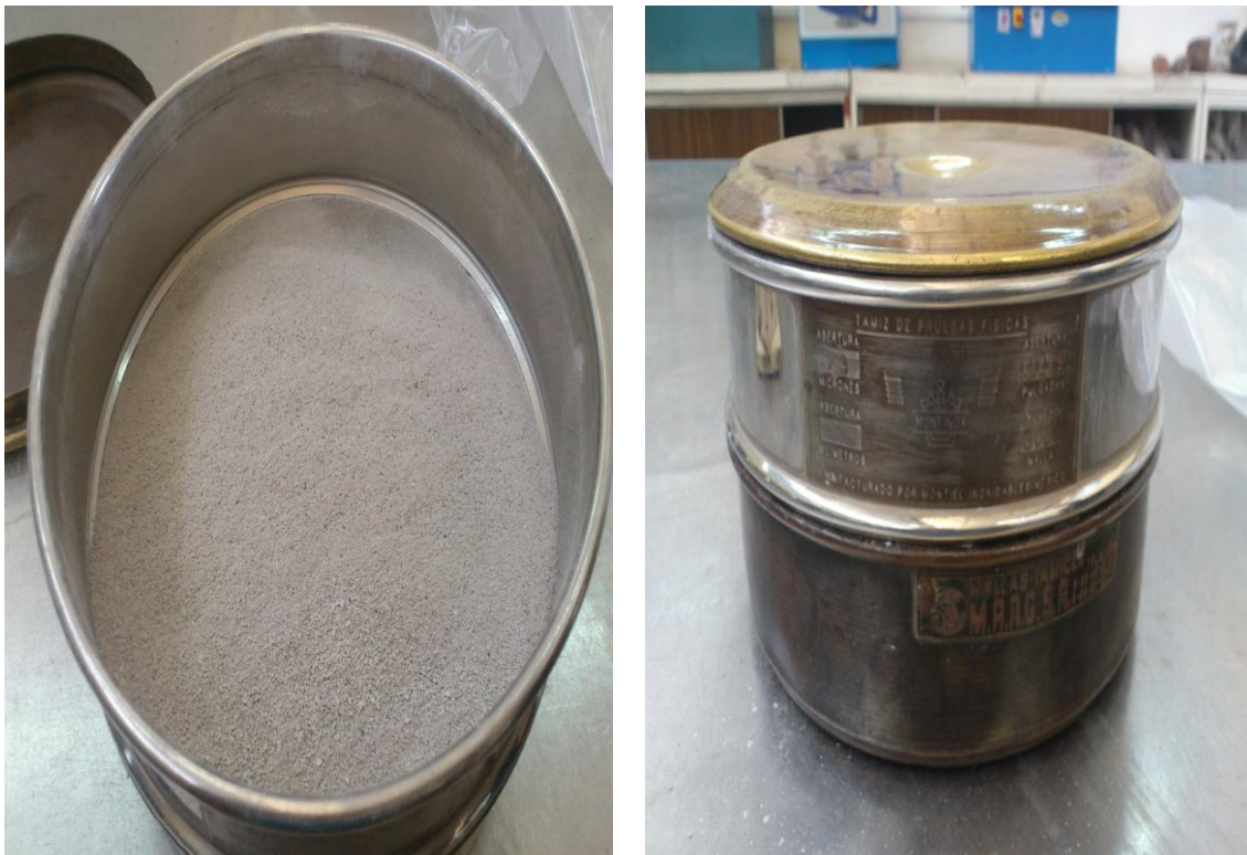
Fig. 24 Cribado en seco de los materiales a través de la malla no. 200.
