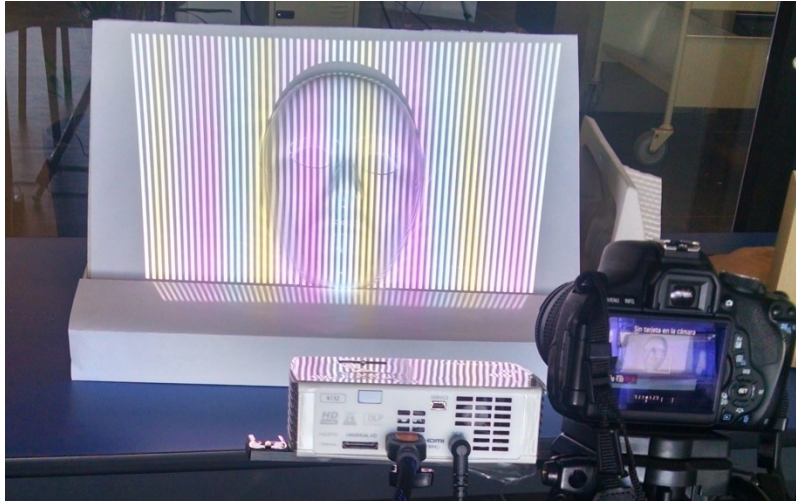
Figura 12. Sistema de captura. Del lado izquierdo puede observarse el proyector, del lado derecho la cámara de adquisición y en el fondo el objeto a digitalizar.
