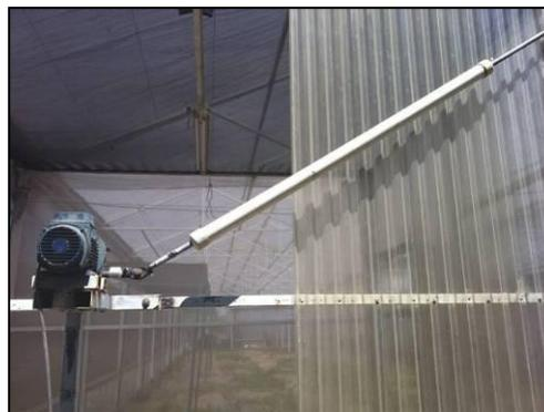
Fig. 5 Sistema de ventanas (cenitales y laterales) del invernadero.
