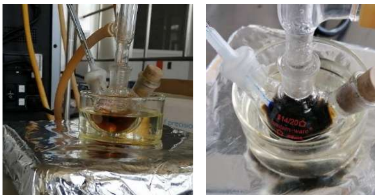
Figura 13. Cambios en la reacción de la síntesis de nanopartículas de paladio tras agregar el agente reductor ( \text{NaBH}_4 ).
