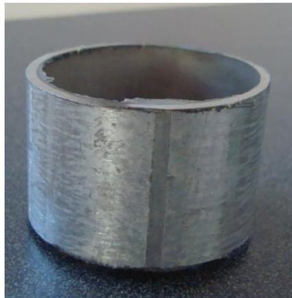
Figura. 3.3.1 Anillo de acero inoxidable utilizado para el remoldeo de las muestras para obtener la curva característica.
