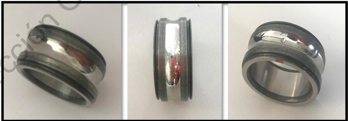
Figura 42. Estados de fallas en rodamientos metálicos
