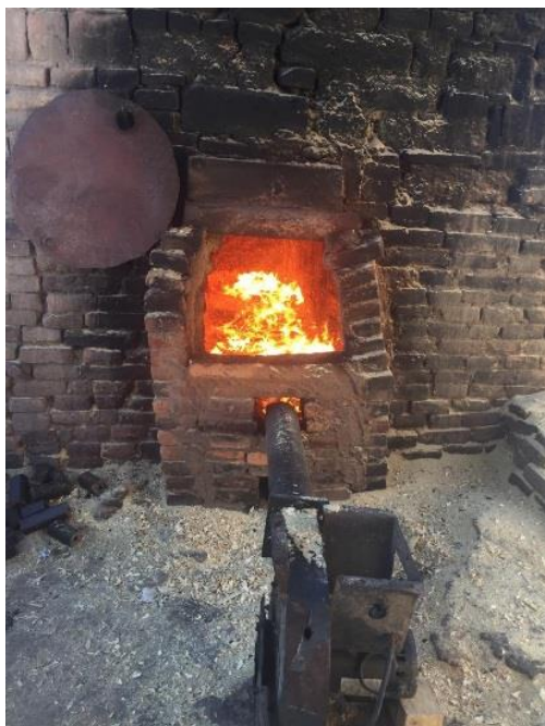
Figura B.7. Horno en operación utilizando briquetas como combustible combustión asistida por un ventilador de aire
