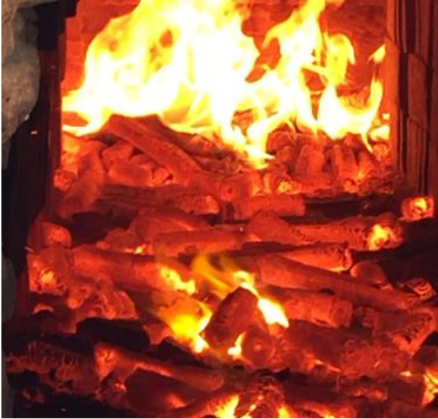
Figura 4.12. Final de la combustión de la briqueta, sin suministro de aire del ventilador. Fuente: Elaboración propia
