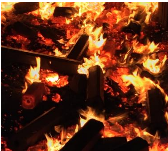
Figura 4.10. Inicio de proceso de combustión de las briquetas están iniciando el proceso de combustión con la ayuda del aire suministrado por el ventilador. Fuente: Elaboración propia
