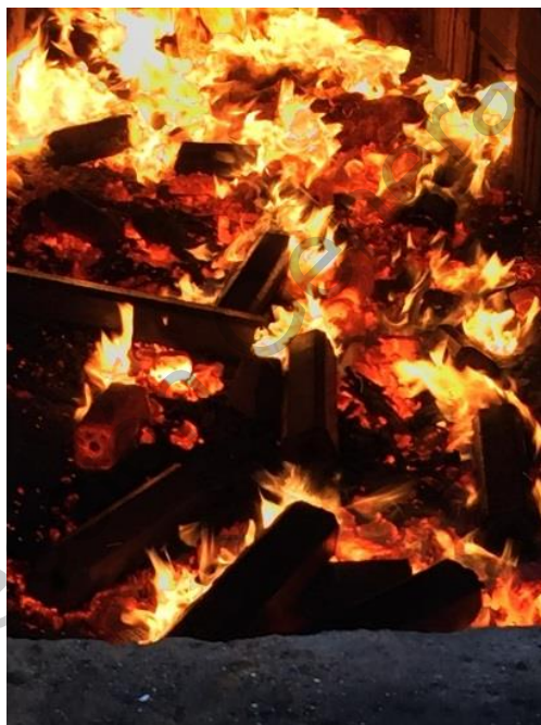
Figura B.14. Combustión de briquetas dentro de la cámara de combustión del horno de fabricación de ladrillos artesanales
