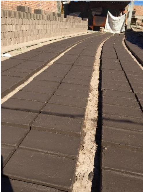
Figura B.3. Proceso de secado de ladrillos a la intemperie
