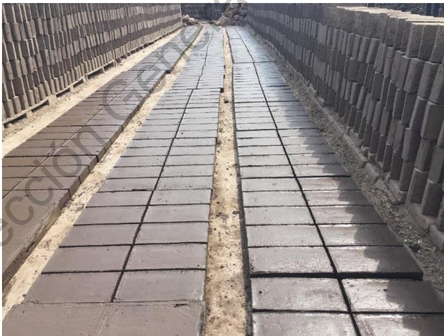
Figura B.10. Proceso de secado de ladrillos a la intemperie
