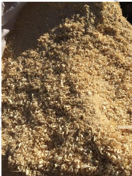
Figura B.2. Aserrín material combustible utilizado en la fabricación de ladrillos artesanales en la comunidad de San Nicolás Tequisquiapan
