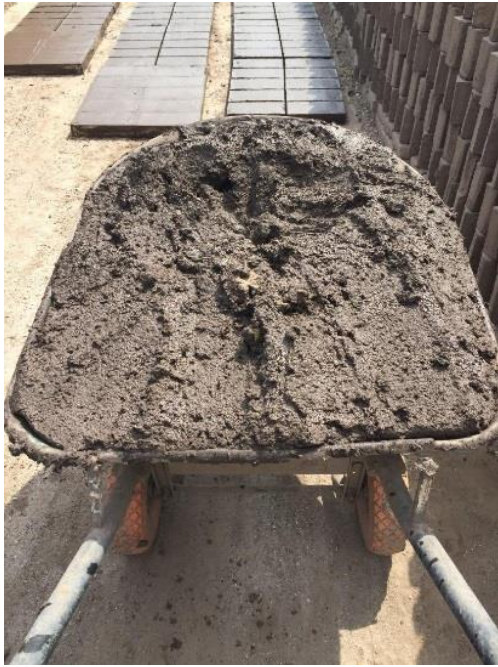
Figura B.5. Mezcla de materias primas usada en la fabricación de ladrillos
