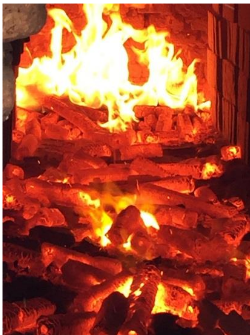
Figura B.13. Combustión de briquetas dentro de la cámara de combustión del horno de fabricación de ladrillos artesanales
