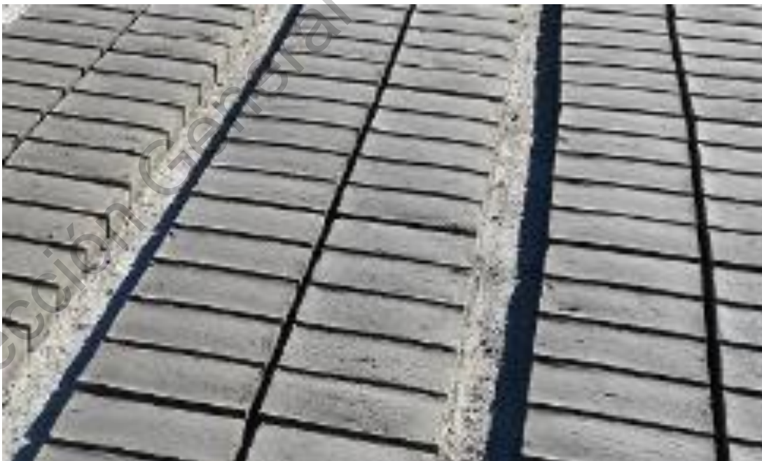
Figura 4.5. Ladrillos crudos son secado al sol previo a ser quemados dentro del horno. Fuente: Elaboración propia
