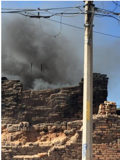
Figura B.11. Parte superior de horno durante quema utilizando aserrín como combustible
