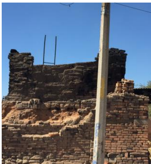
Figura 4.13. Quema usando briquetas. Fuente: Elaboración propia
