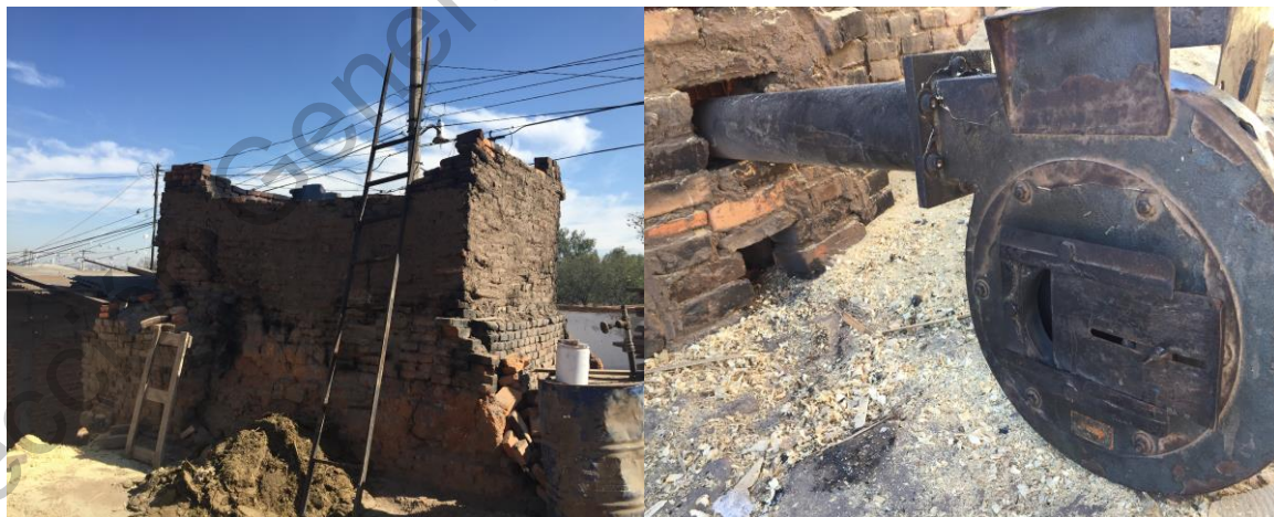
Figura 4.8. Horno tipo Cielo Abierto de fabricación de ladrillo rojo artesanal y ventilador de suministro de aire combustión. Fuente: Elaboración propia
