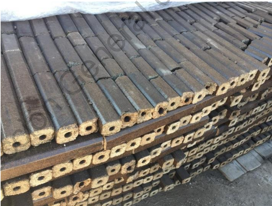
Figura B.4. Lote de briquetas de madera de pino utilizadas durante la prueba de fabricación de ladrillos
