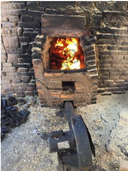
Figura B.6. Horno en operación utilizando briquetas como combustible combustión asistida por un ventilador de aire
