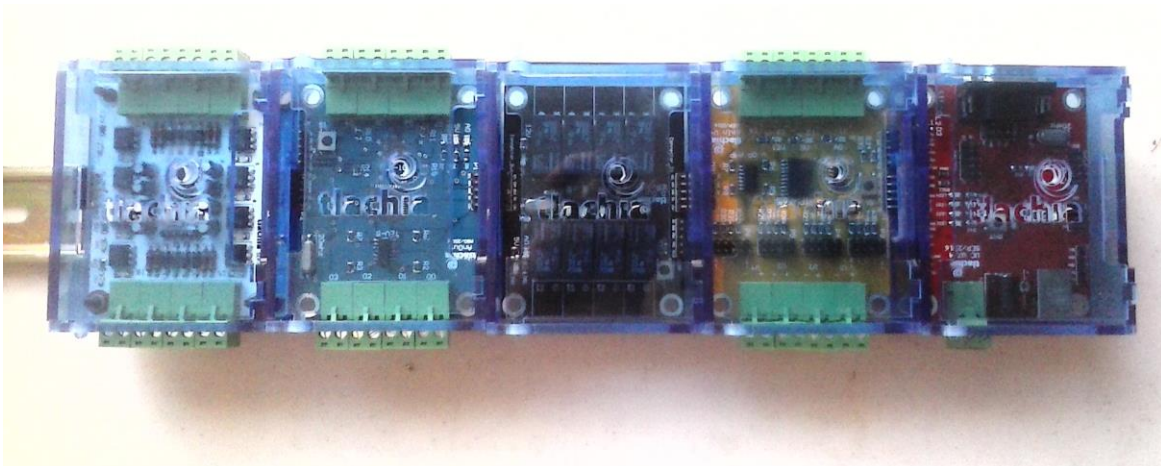
Figura 4.7. Sistema SCADA Completo.
