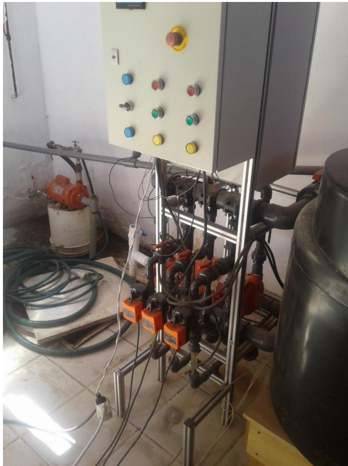
Figura 4.1. Prototipo final de la máquina de fertirriego implementando el control manual y automático.
