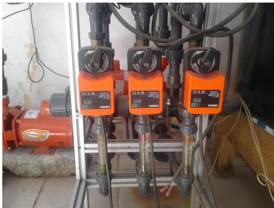
Figura 3.12. Servo-válvulas para regular el flujo de nutrientes y fertilizantes de la máquina de fertirriego.
