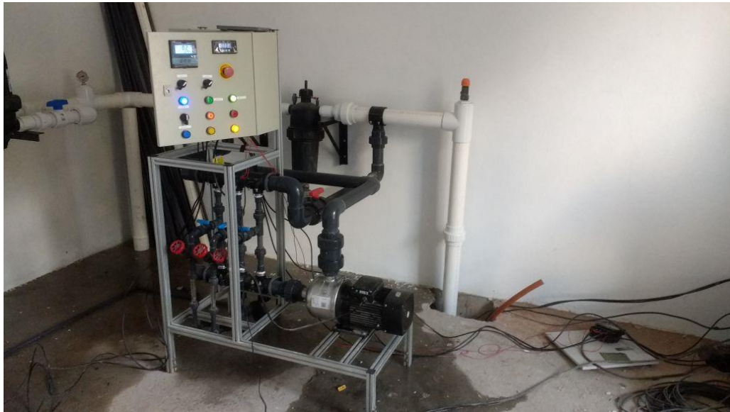
Figura 4.12. Máquina de fertirriego manual instalada en un invernadero de San Luis Potosí.
