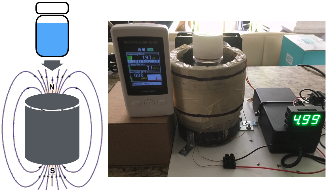
Figura 42. Diseño del biorreactor de campo magnético aplicado - biorreactor V.
