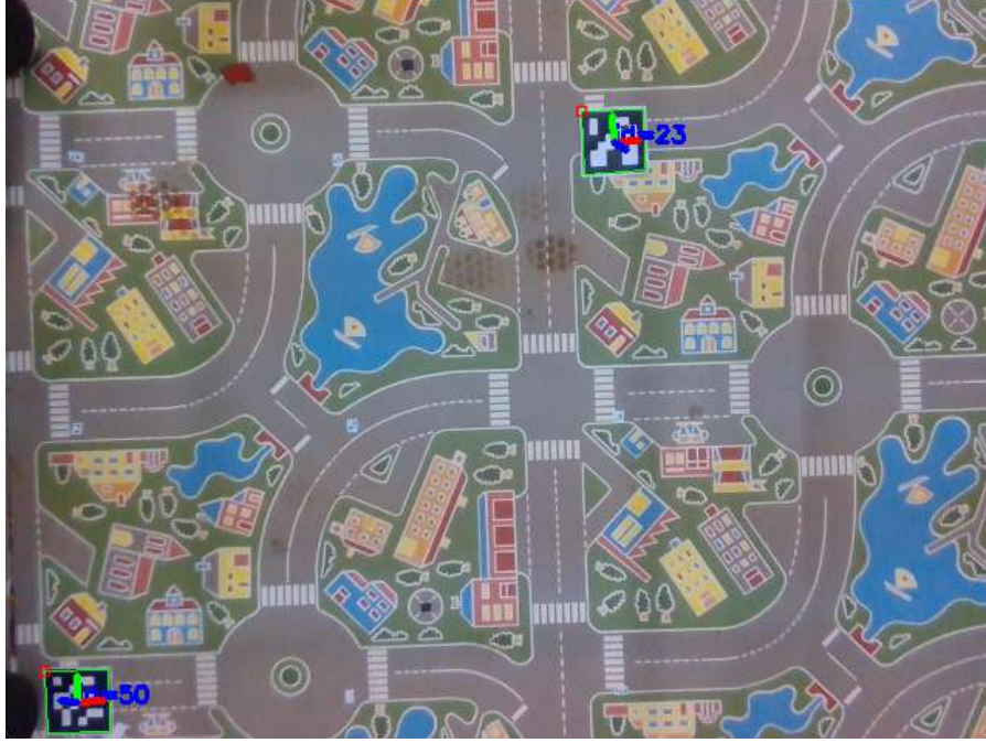
Figura 5.6: Vista de la cámara y presencia de marcadores ArUco.
