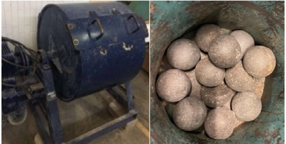
FIGURA 3. Izquierda: equipo de abrasión Los Ángeles FI-UAQ. Derecha: esferas de molienda.
