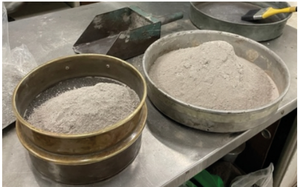
FIGURA 4. Control granulométrico de agregados reciclados de concreto.
