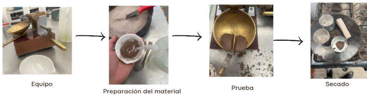
Fig. 10. Elaboración de prueba de límites de atterberg
