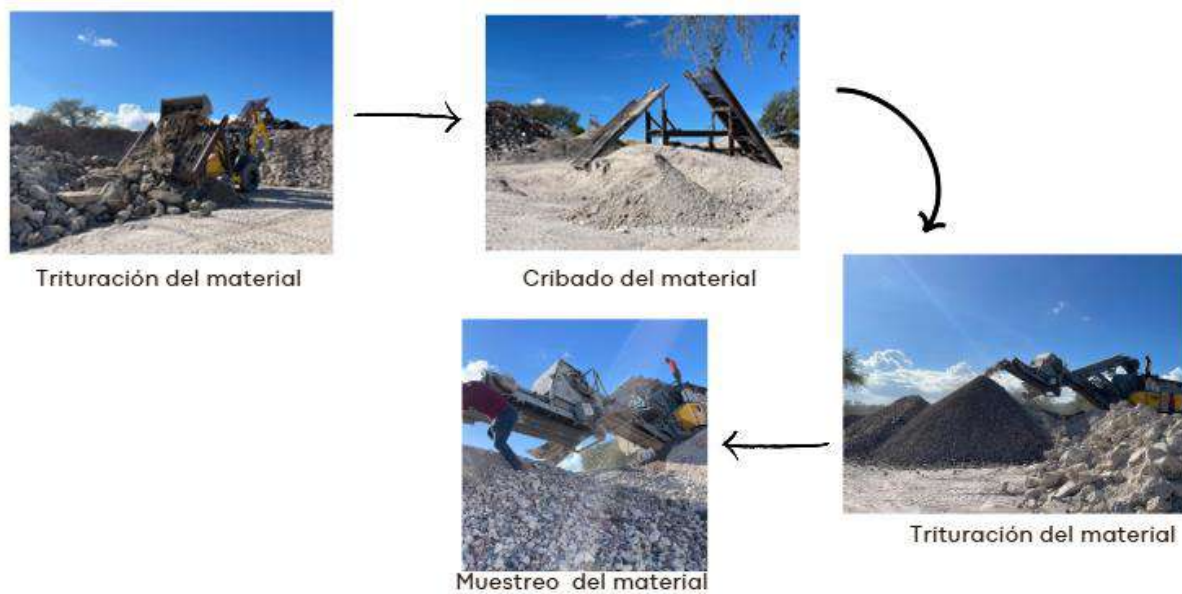
Fig. 6 Proceso de obtención del material reciclado
