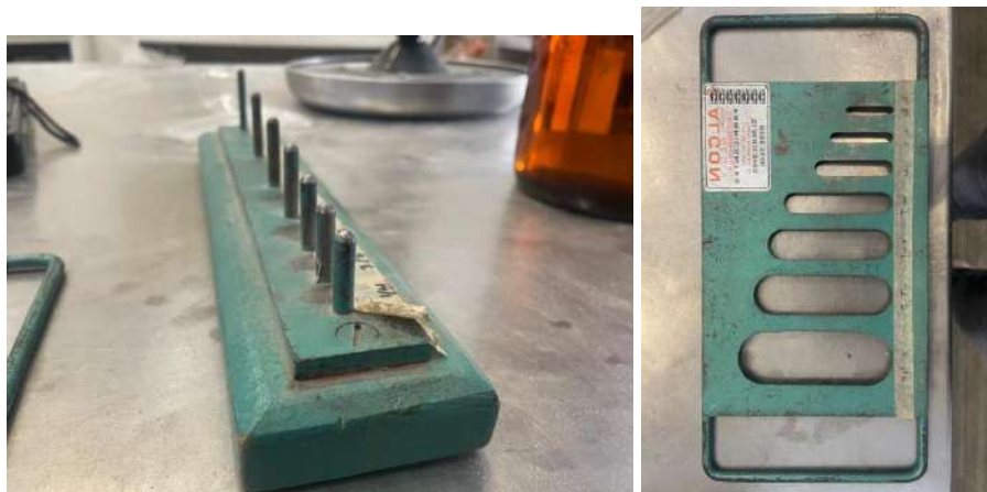
Fig 12. Equipo para prueba de alargamiento y lajeo
