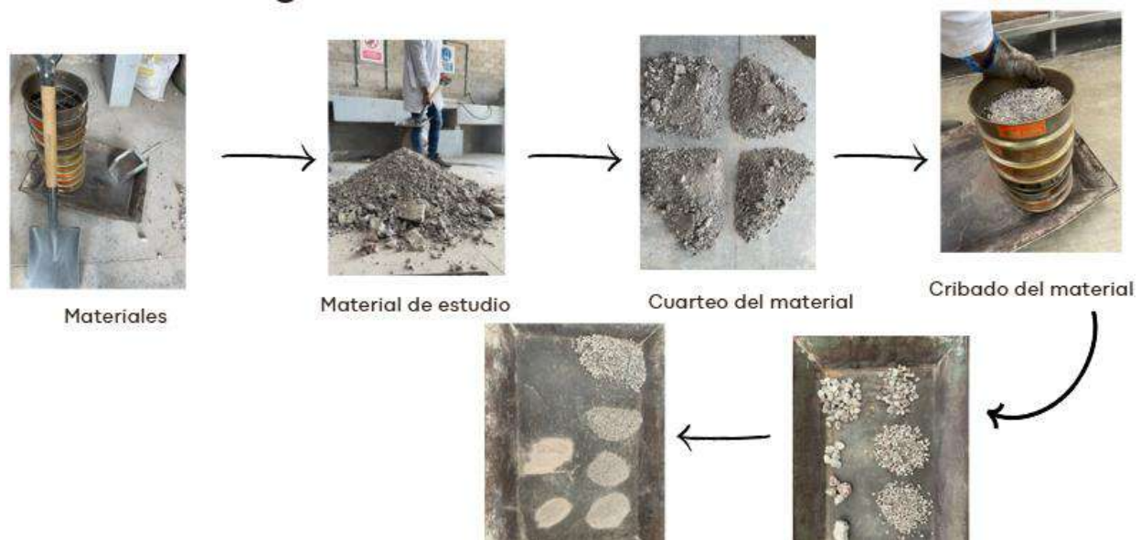
Fig. 7. Proceso del análisis granulométrico
