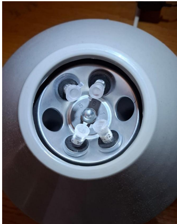
Figura 13. Adaptación de tubos Eppendorf para centrifugación.
