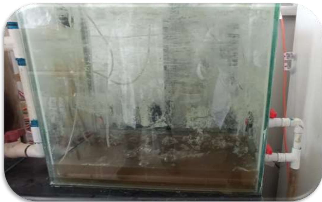
Figura 3. Reactor biológico de lecho fijo con sistema de difusión ubicado en la parte inferior.
