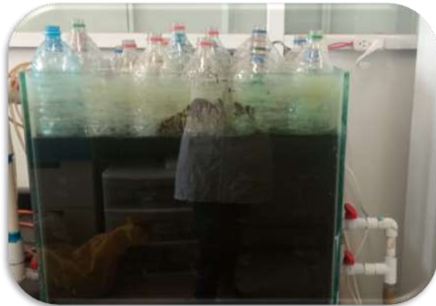
Figura 5. Configuración final del reactor biológico posterior a la inoculación con lodos.
