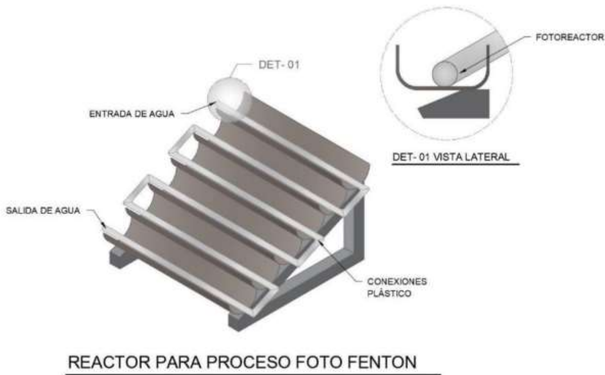
Figura 9. Esquema del reactor para el proceso foto Fenton solar.
