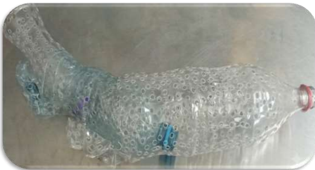
Figura 4. Ensamblaje de botellas PET utilizadas en el reactor biológico.
