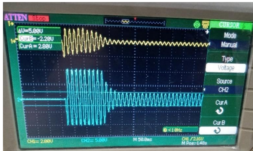
Figura 34 Lectura del sensor del estado estacionario (Autoría propia)
