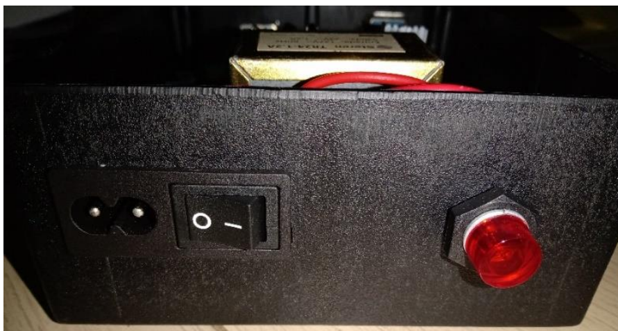
Figura 47 Interruptor y foco piloto de la caja (Autoría propia)
