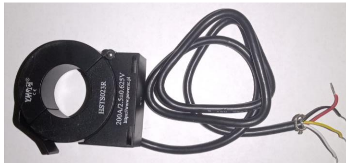
Figura 5 Sensor de corriente de efecto Hall HSTS023R (Autoría propia)
