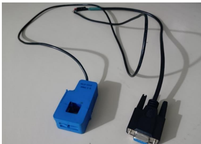
Figura 68 Sensor de toroide o basado en transformadores con su cable 8 bits hembra (Autoría propia)
