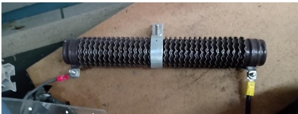
Figura 59 Resistencia para las espiras en corto (Autoría propia)
