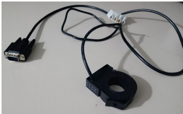
Figura 69 Sensor de efecto Hall con su cable 8 bits macho (Autoría propia)
