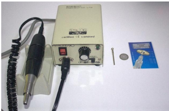
Fig 3. Se utilizó micromotor para el recorte de los dientes
