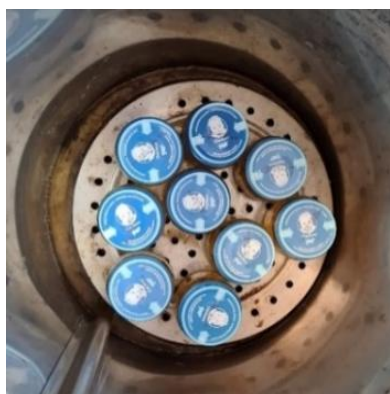
Figura 5. Frascos Gerber colocados en olla autoclavable.
