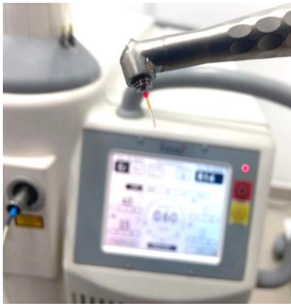
Figura 10. Punta de cuarzo de 400 µm de diámetro (XPulse 400/14, Fotona).
