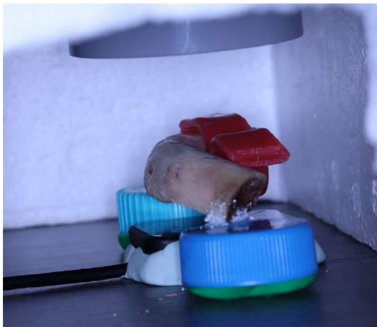
Figura 2. Distancia tubo de rayos X-objetivo-receptor precisa y reproducible.
