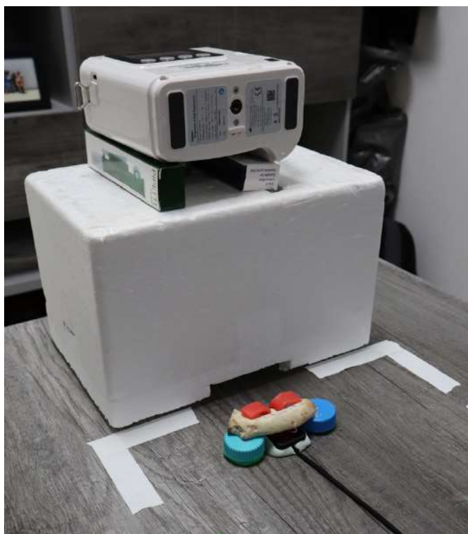
Figura 4. Máquina de rayos X marca Runyes y base utilizada para asegurar una posición reproducible.
