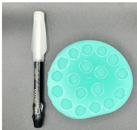
Fig 6. Fabricación especímenes de resina forma
