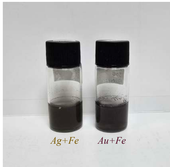
Figura 4.2: Muestras de Ag+Fe y Au+Fe obtenidas por el proceso de PLAL. Conjunto de muestras B.
