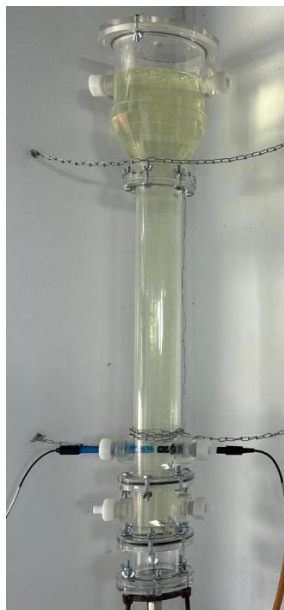
Figura 4. Montaje de biorreactor air-lift
