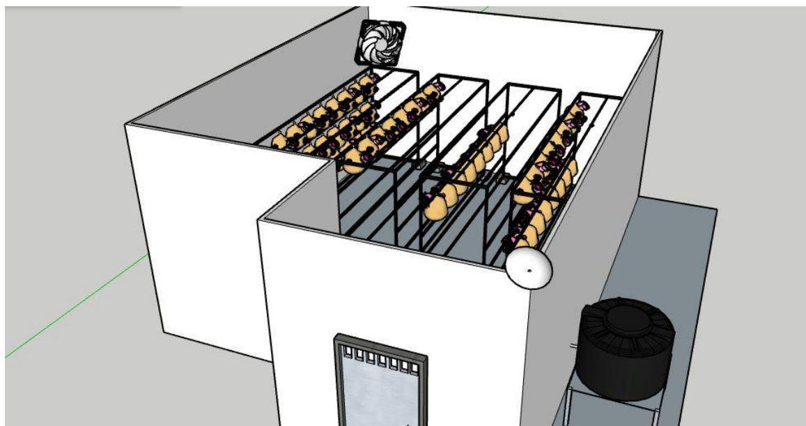
Figura 5. Diseño de la cámara de crecimiento vista superior dorsal.
