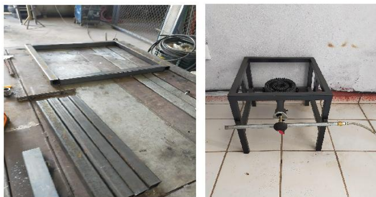
Figura 17. Construcción de estufas de tipo industrial.
