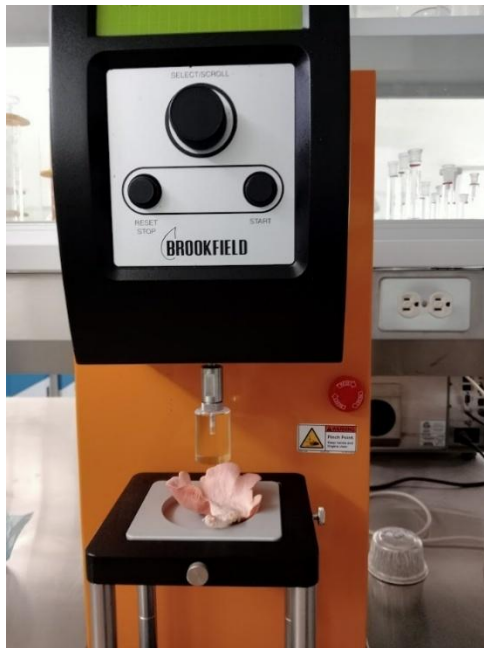
Figura 14. Analizador de textura (TA-HDi Model Texture Analyzer; TexturePro CT V1.6 Build).
