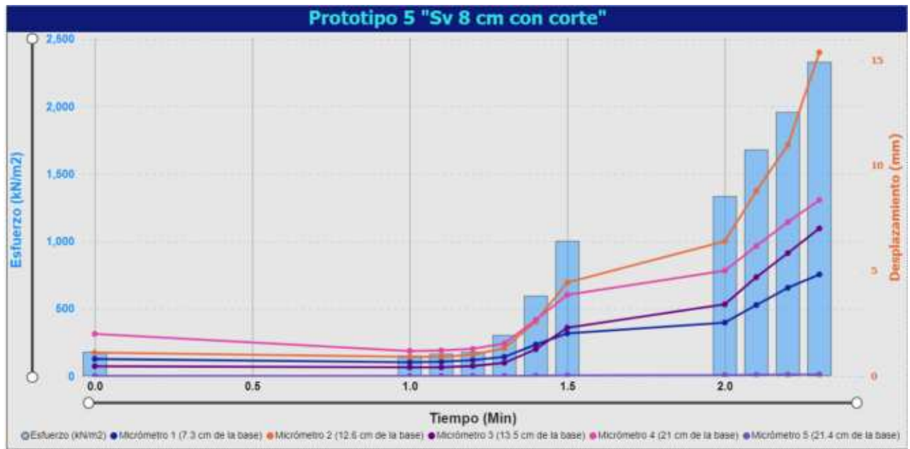
Figura 59. Comportamiento Tiempo y Desplazamiento de los 5 micrómetros Prototipo 5.
