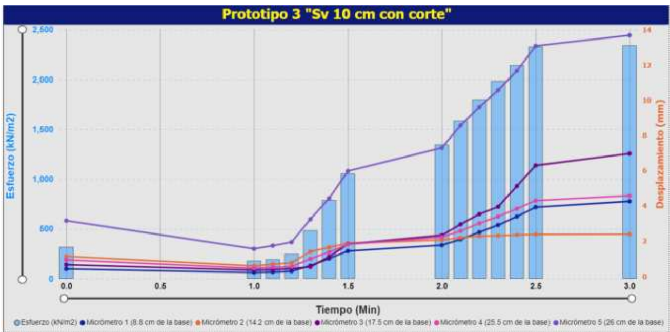
Figura 53. Comportamiento Tiempo y Desplazamiento de los 5 micrómetros Prototipo 3. Fuente: Elaboración Propia.
