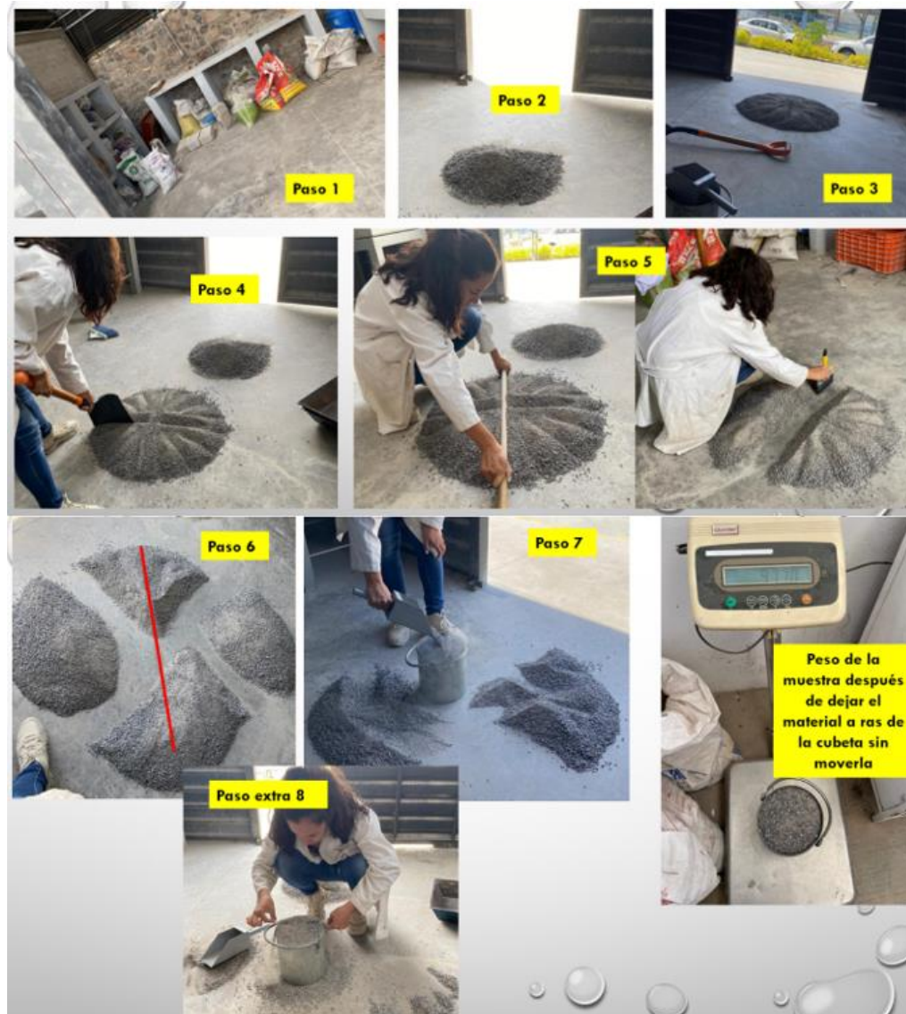
Figura 13. Practica estándar para reducción de muestras de agregado al tamaño de prueba en la universidad UAQ.
