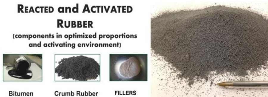
Figura 3-4 Componentes principales del polvo de neumático pretratado utilizando la tecnología Reacted and Activated Rubber.
