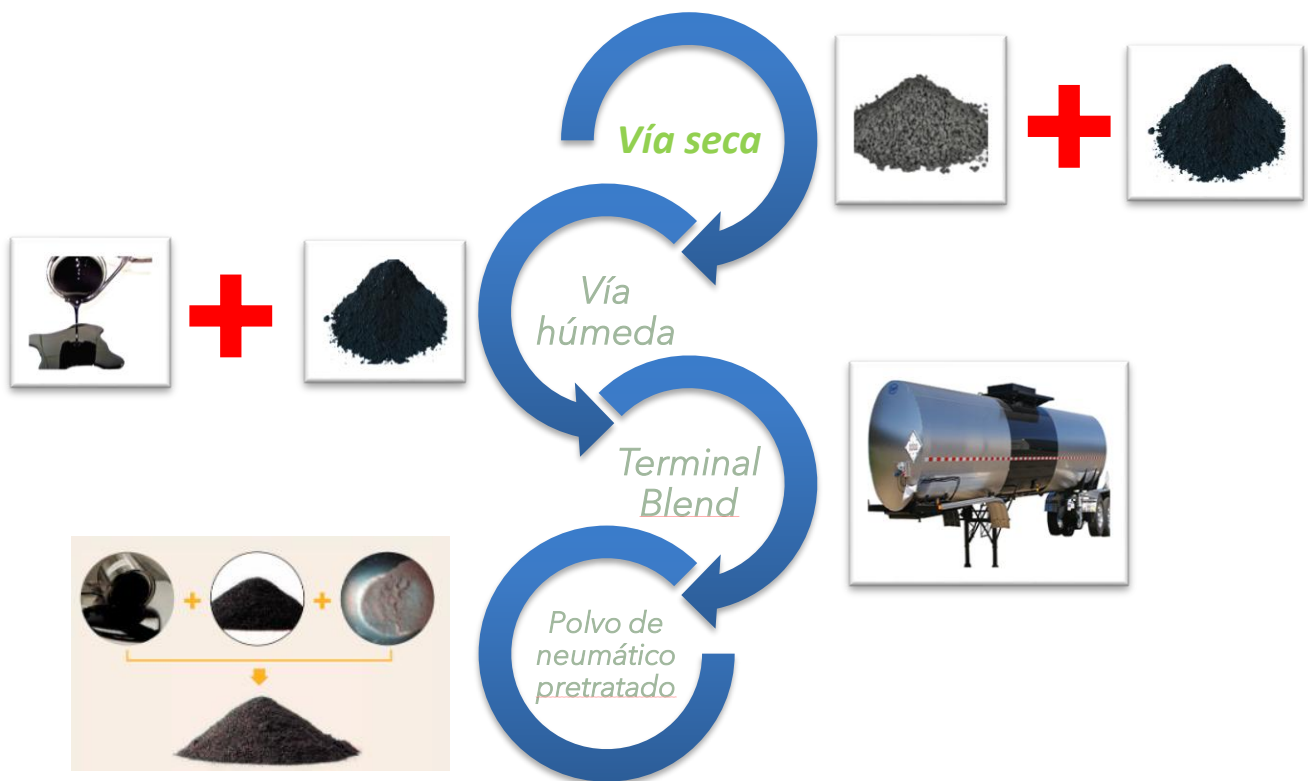
Figura 3-3 Tipos de adición de NFU en las mezclas asfálticas de acuerdo con el orden cronológico de investigación.
