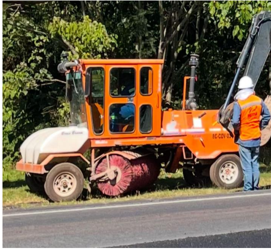
Figura 6-10 Equipo utilizado para proceso de fresado y barrido.
