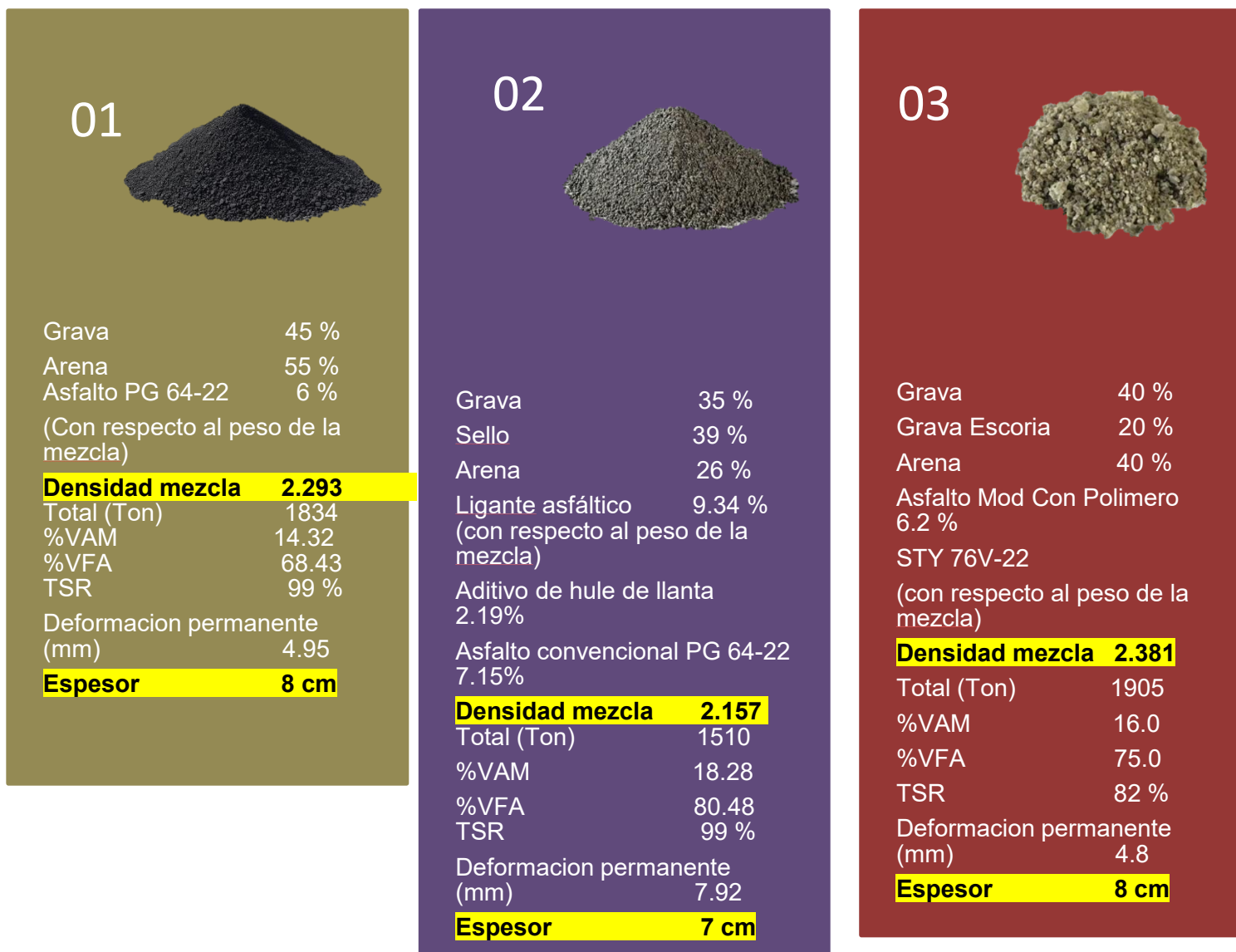
Figura 6-6 Resumen de los resultados de diseño de las tres alternativas analizadas.
