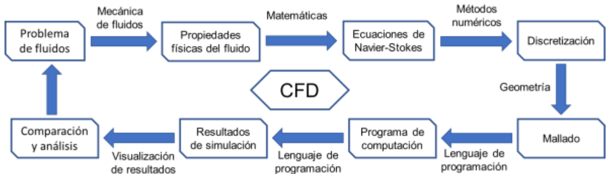
Figura 2. Diagrama de flujo de trabajo en la Dinámica de Fluidos Computacionales (CFD) (Zawawi et al., 2018).
