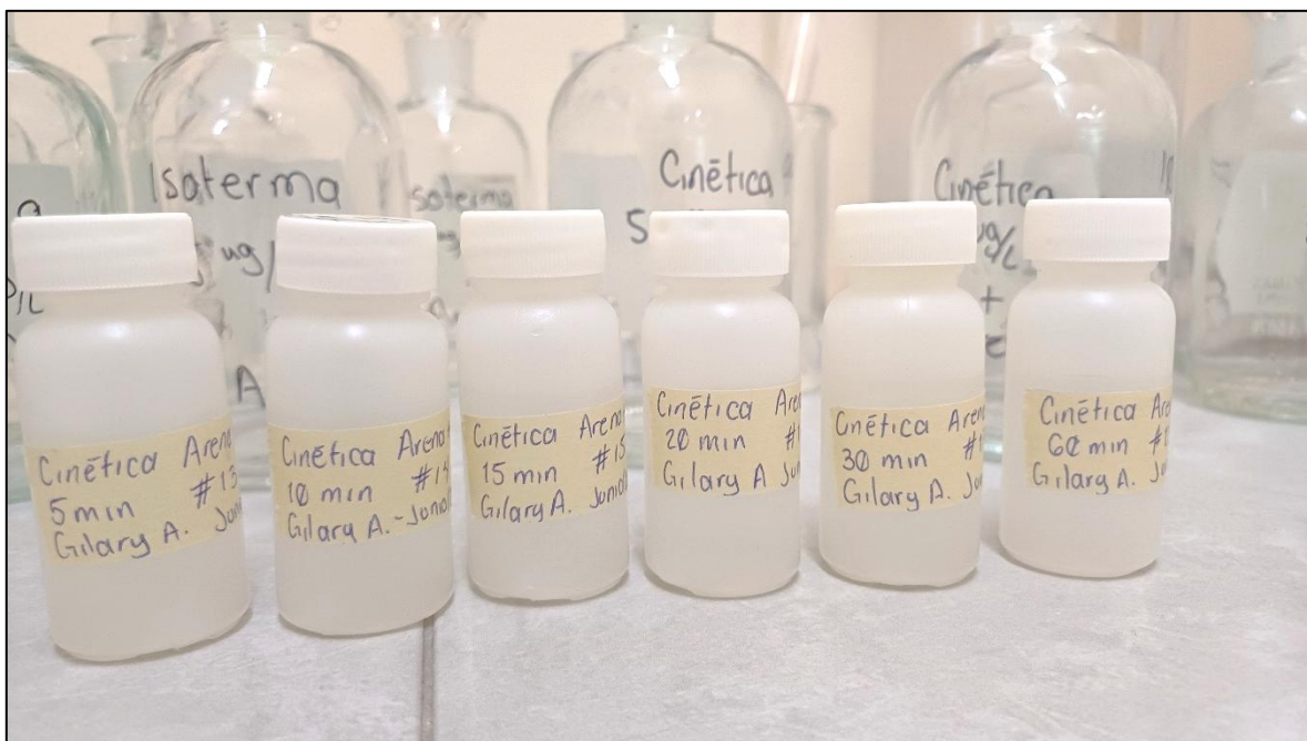
Figura 44. Frascos de polietileno para el almacenamiento de extractos ácidos del experimento de cinética de adsorción
