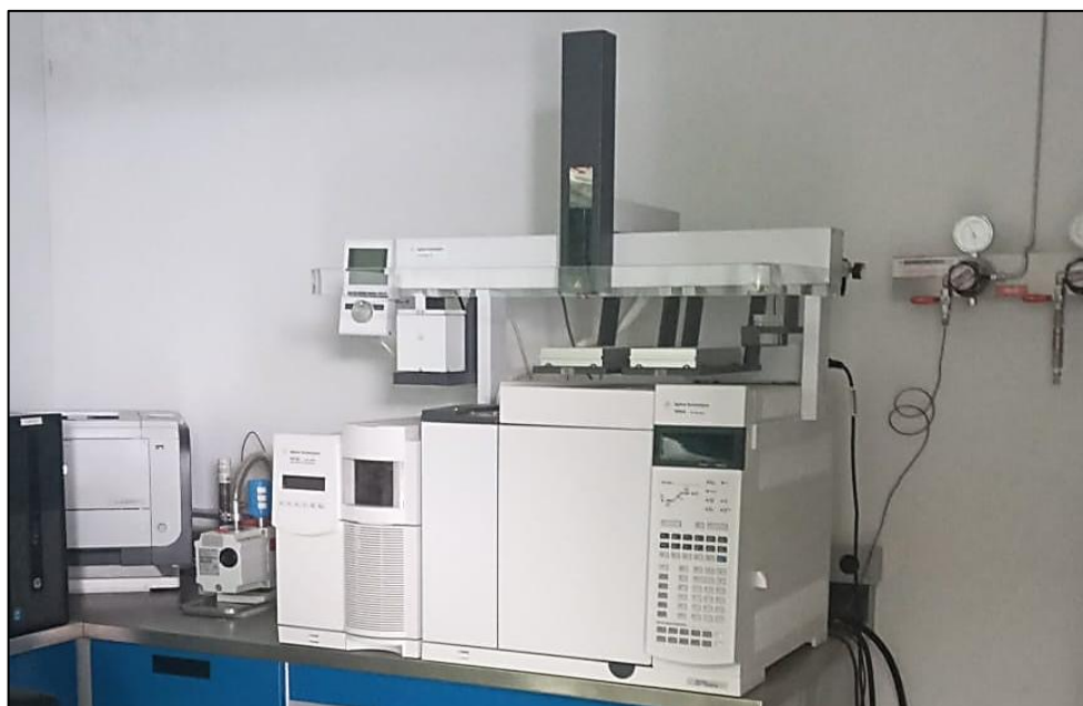
Figura 11. Cromatógrafo Agilent 5975C utilizado para la obtención del perfil fitoquímico
