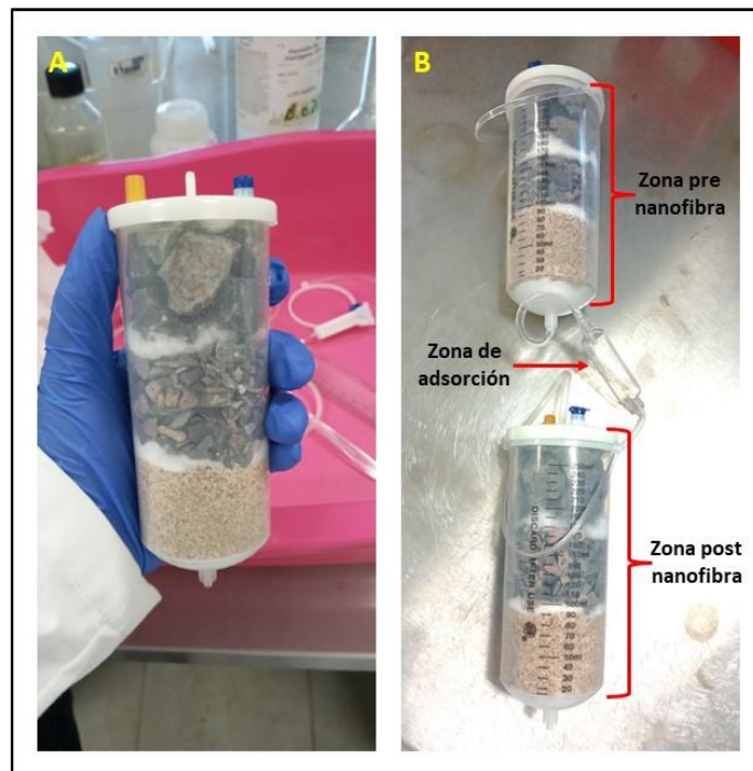
Figura 36. Construcción de los filtros
