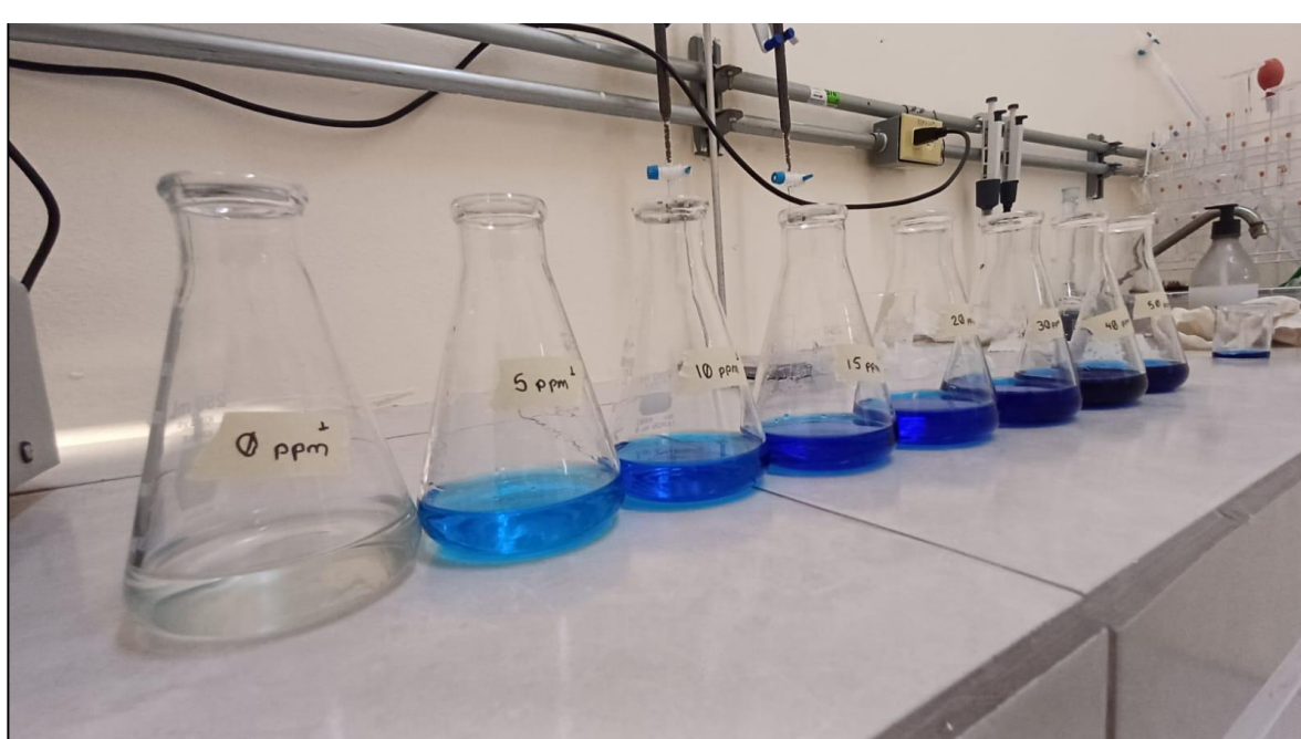
Figura 43. Curva de calibración de azul de metileno para la técnica de isoterma de adsorción con carbón activado
