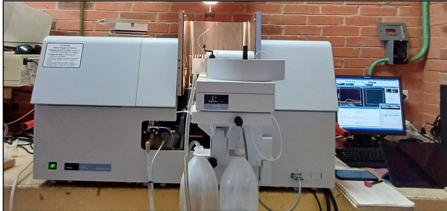
Figura 12. Espectrofotómetro de absorción atómica AAAnalyst 800, Perkin-Elmer utilizado
