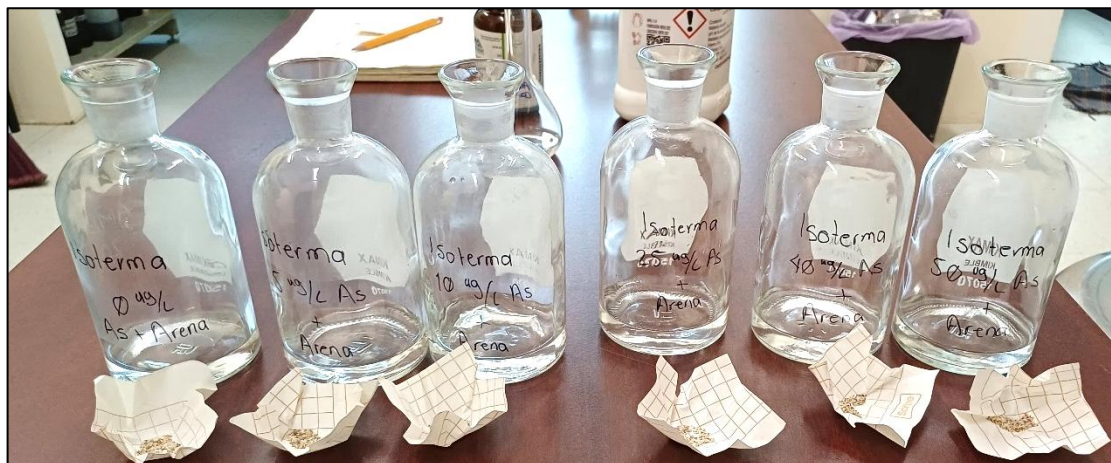
Figura 14. Botellas Winkler en la experimentación de isoterma de adsorción.
