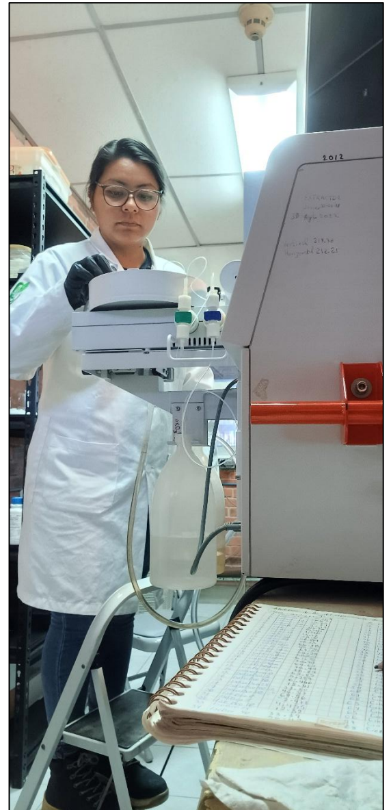
Figura 42. Inserción de extractos ácidos en automuestreador de espectrofotómetro de absorción atómica
