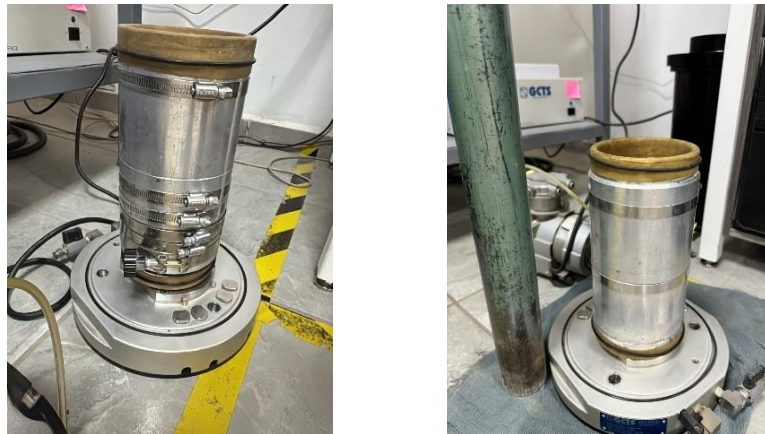
Figura 45. Molde para especímenes.
