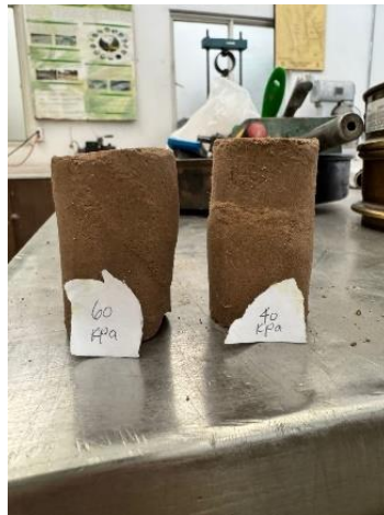
Figura 49. Falla en probetas.
