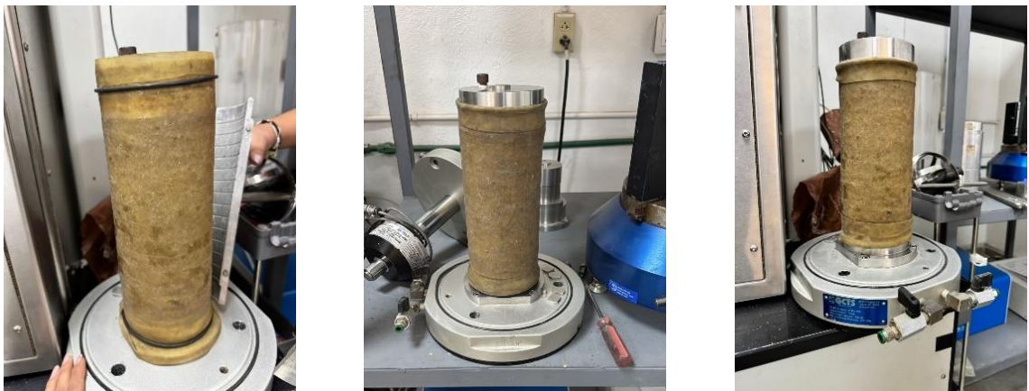
Figura 46. Probeta para ensayo triaxial.
