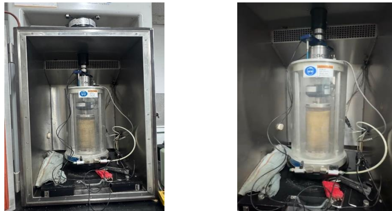
Figura 54. Ejecución de pruebas triaxiales multietapa.
