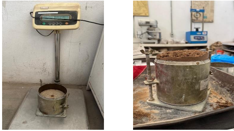
Figura 41. Espécimen para prueba de CBR.
