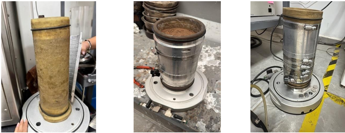
Figura 53. Elaboración de especímenes para prueba triaxial cíclica.
