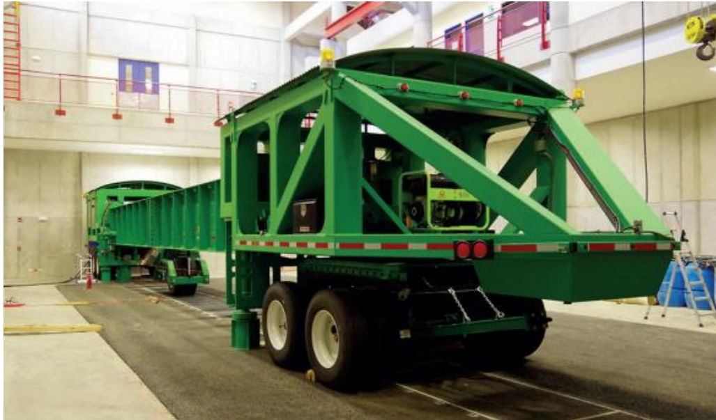
Figura 17. Equipo para ensayo de pavimento a escala real. (Leiva, Camacho, & Aguiar, 2016)
