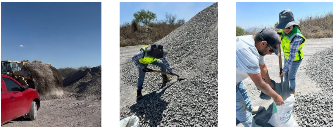
Figura 30. Muestreo de material en banco "Corporativo El Bajío"
