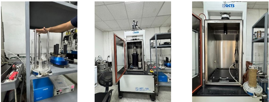
Figura 52. Equipo para ensayo triaxial.
