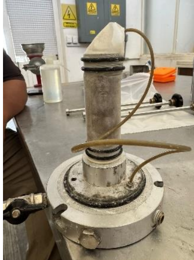
Figura 47. Espécimen colocado en base de equipo triaxial.
