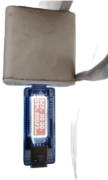
Figura 6.12: Medición de consumo energético por parte del sistema embebido.
