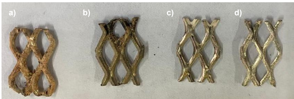
Figura 34. Deposición por electroforesis (EPD) de \text{Bi}_{0.5}\text{Na}_{0.5}\text{TiO}_3 en medio acuoso y alcohólico, variando la proporción de aglutinante/solvente: a) 50/50 y b) 70/30 en agua, c) 50/50 y d) 70/30 en etanol
