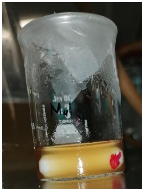
Figura 17 Solución homogénea de PVA (6%), quitosano (.55%) y mucílago de nopal (3%)
