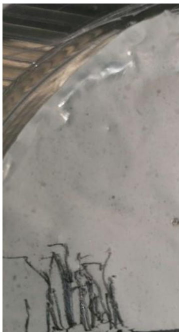
Figura 16 Visualización de rayaduras que no rompieron la membrana
