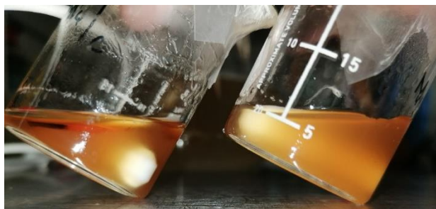
Figura 12 Comparación de dos síntesis de quitosano, mucílago y PVA: con y sin Tritón
