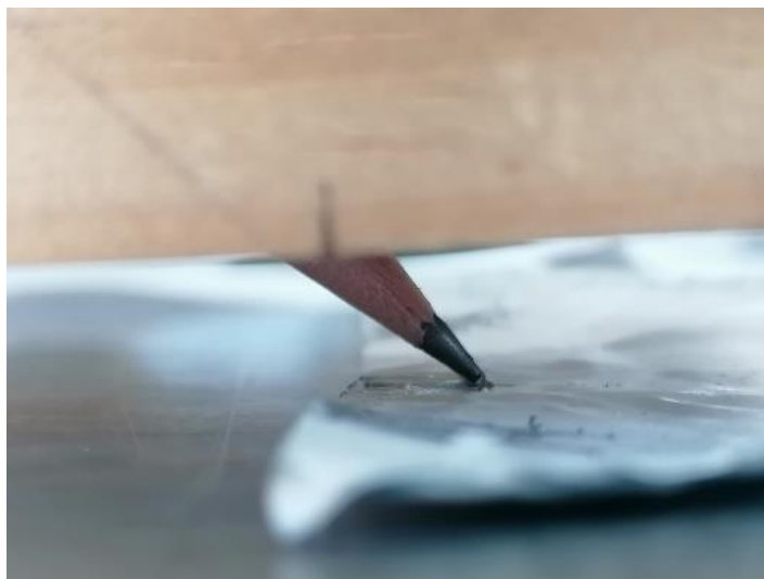
Ilustración 15 Recorrido de la rayadura finalizado con un ángulo de incidencia de 45°
