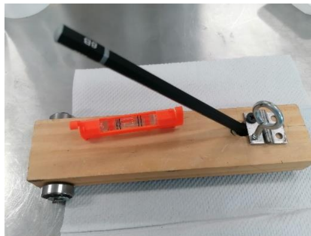
Figura 13 Carrito de la prueba Wolff-Wilborn adaptado y calibrado
